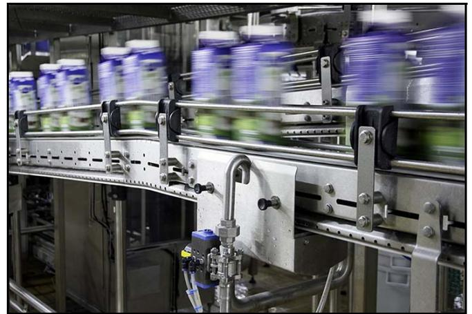
Ligne de conditionnement de lait avec nettoyage en place
