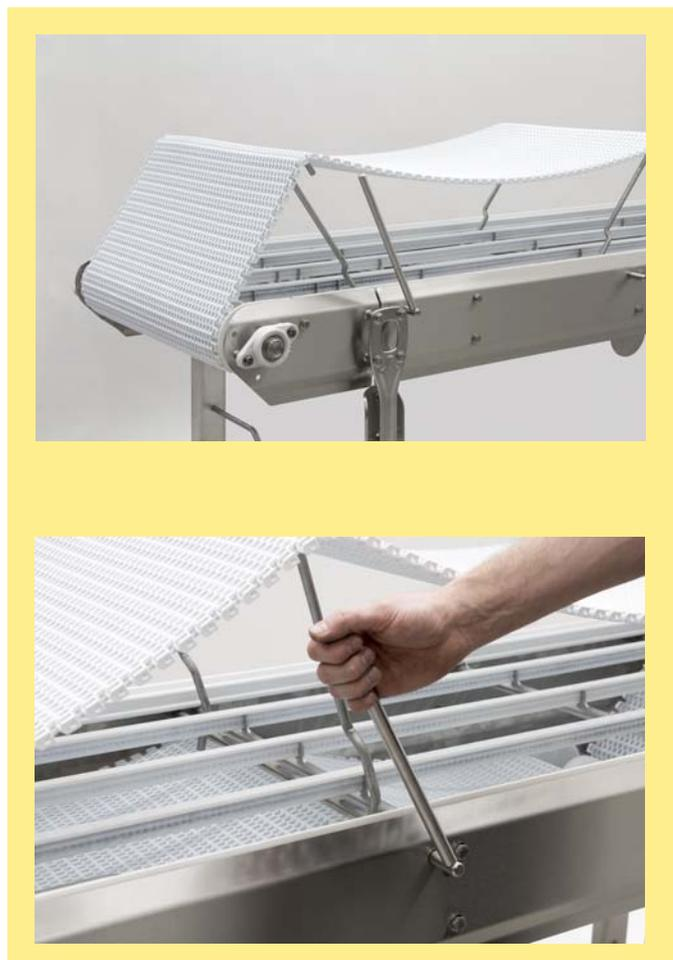
Pour simplifier le processus de nettoyage, FlexLink propose des bras de levage de chaîne pour convoyeurs rectilignes. Contacter FlexLink pour obtenir plus d'informations.
