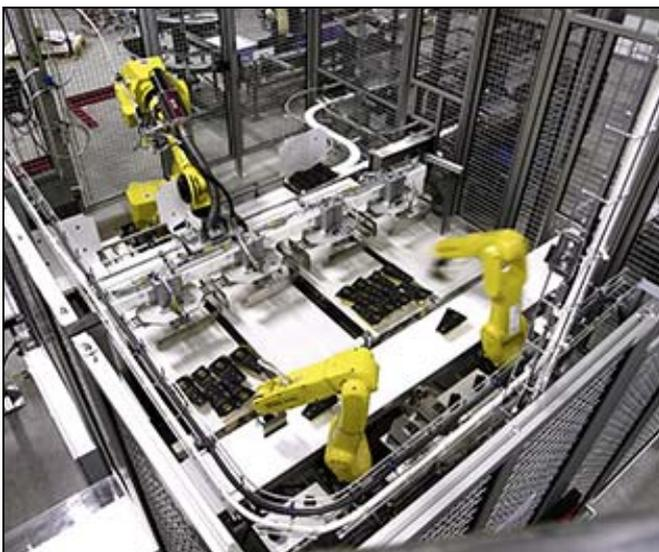
*Protections de sécurité et application de prélèvement robotisé*
