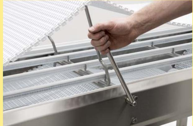
Pour simplifier le processus de nettoyage, FlexLink propose des bras de levage de chaîne pour convoyeurs rectilignes. Contacter FlexLink pour obtenir plus d'informations.
