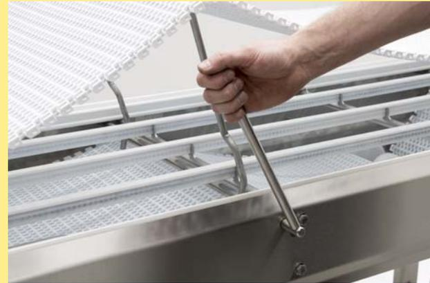
Pour simplifier le processus de nettoyage, FlexLink propose des bras de levage de chaîne pour convoyeurs rectilignes. Contacter FlexLink pour obtenir plus d'informations.
