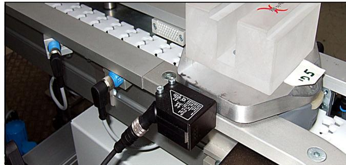
Das Palettensystem X85 umfasst Paletten in vier Größen. Eine Palette besteht aus einer Grundplatte aus Aluminiumdruckguss und zwei konfigurierbaren Führungsscheiben/Palettenfüßen. Produktspezifische Haltevorrichtungen sind an der Palettenbasis angebracht.
