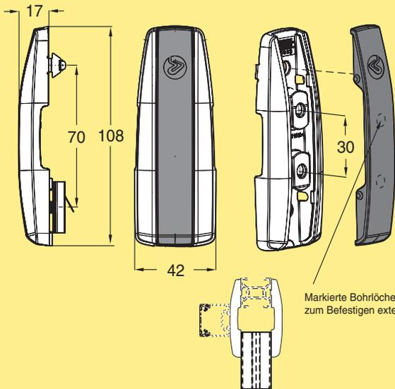
Markierte Bohrlöcher, 2x 6,5 mm
