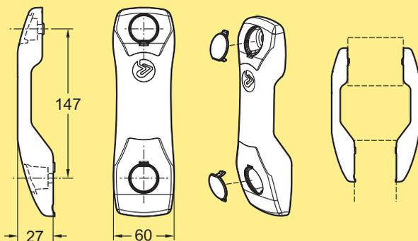
Verbindungsstück für Tragprofile für X65, Typ CS
