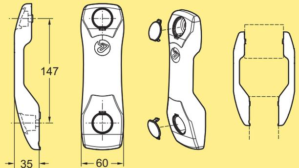
Verbindungsstück für Tragprofile für X85, Typ CS
