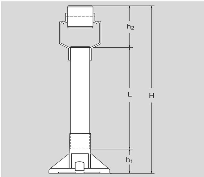
Die Führungsprofillänge, die für eine bestimmte Förderhöhe H erforderlich ist, hängt von der Förderergröße, dem Fußtyp und dem Verbindungsstück für die Führungsprofile ab. Siehe Abbildung. Hier werden Verbindungsstücke für Tragprofile Typ CS verwendet. Informationen zu den Verbindungsprofilen siehe Seite 348. Füße: siehe Seite 351.
