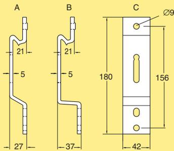
Verbindungsprofil, Typ CS
