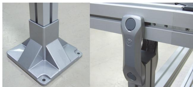
I convogliatori sono fissati in posizione da una gamma di componenti di supporto ben bilanciati con staffe per travi, profili portanti, basamenti, ecc.
