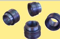
Zum Bau von Nicht-Standard-Paletten in Kombination mit kundenseitig gelieferten Palettenplatten. Die Buchsen sind für eine Plattenstärke von 5 mm vorgesehen und müssen in Ø16-mm-Löcher eingepresst werden.
