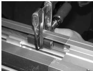
7 Befestigen Sie die Schiene mit ISO 7049 4,2 x 9,5-Blechschiene. Siehe „Stützschiene für Gleitbögen XH“ auf Seite 238. (niemals längere Schrauben als 9,5 mm benutzen).
