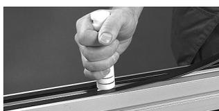
**Verbinden von Gleitschiene**
