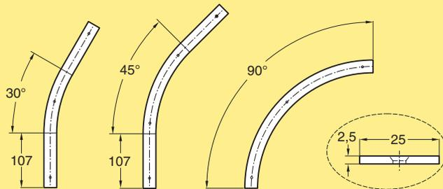
Gleitschiene für Bögen, gehärteter Stahl
