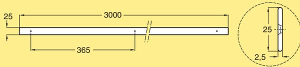
Gleitschiene, gehärteter Stahl
