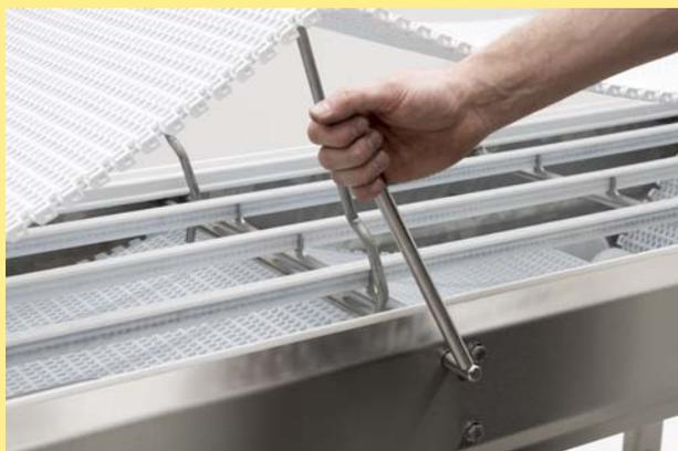
Чтобы упростить процесс очистки, FlexLink предлагает подъемные рычаги для цепи прямоходных конвейеров. Для получения дополнительной информации обратитесь в FlexLink.
