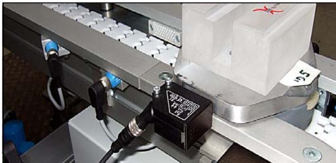
El sistema de palets X85 incluye palets en cuatro tamaños. Un palet consta de una base de palet de aluminio fundido y dos discos de guía de plástico con placas de deslizamiento en la parte inferior. Los útiles específicos del producto se colocan en la base del palet.
