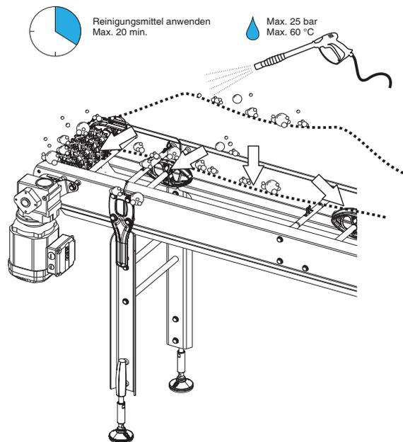
In der Hauptreinigungsphase wird hartnäckiger Schmutz auf der Mattenkette (z. B. Öle oder Fette) mithilfe chemischer Reinigungsmittel entfernt. Reinigungsmittel werden generell in Schaumform aufgetragen. In der Praxis wird die Mattenkette allerdings unter bestimmten Umständen auch manuell geschrubbt.
