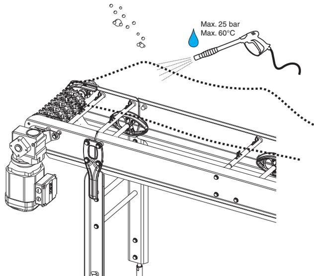
Es dürfen keine Reinigungsmittel auf den Oberflächen verbleiben. Daher sollten die Chemikalien mit lauwarmem Trinkwasser abgespült werden. Danach sollte die Anlage trocknen.
