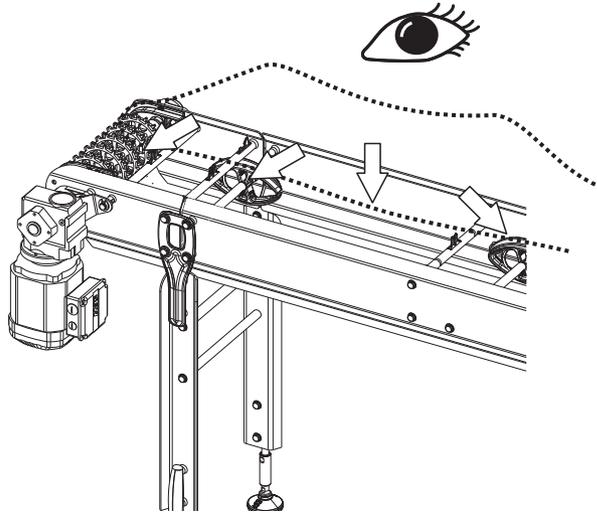
Prüfen Sie das Reinigungsergebnis visuell und per Hand, fühlen Sie, dass die Erde entfernt wurde. Hier kann auch eine passende Methode, z. B. ATP-Kit oder proteinbasiertes Kit, verwendet werden.
