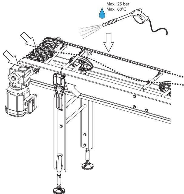
Spülen Sie beim Vorspülen Erde mit warmem Wasser (max. 60 °C) bei niedrigem Druck (max. 25 bar) ab.
