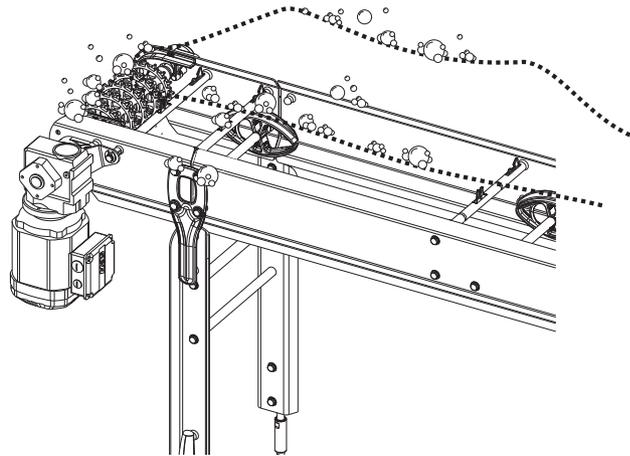
Die Desinfektion sollte nicht mit Druck angewendet werden, jedoch mit einer speziellen Düse zum Besprühen der Desinfektionsmittellösung auf alle Oberflächen. Lassen Sie sie etwa 10–15 min einwirken, (befolgen Sie die Anweisungen des Lieferanten der Desinfektionsmittellösung).
