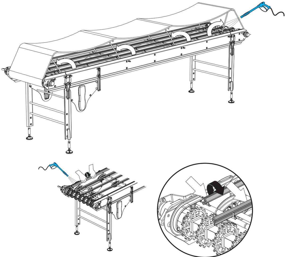
Umlenkeinheiten-Räder haben ein offenes Design und können einfach beiseitegeschoben werden, um die Reinigung der Welle zu vereinfachen. Wenn das Förderband entfernt wird, können auch die Zahnräder beiseitegeschoben werden.
