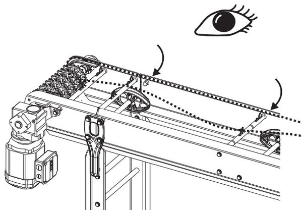
Prüfen Sie das Ergebnis der endgültigen Reinigung und Desinfektion, bevor die Produktion erneut gestartet wird. Ein geeignetes Kultivierungsverfahren sollte nach dem internen Kontrollsystem des Lebensmittelherstellers verwendet werden (Tupfer, Kontaktplatte).
