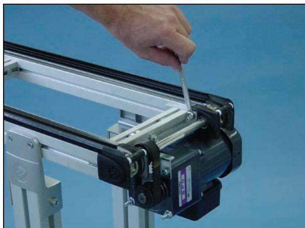
10 旋紧传动装置外侧的螺丝，使用 3 mm 内六角扳手。
