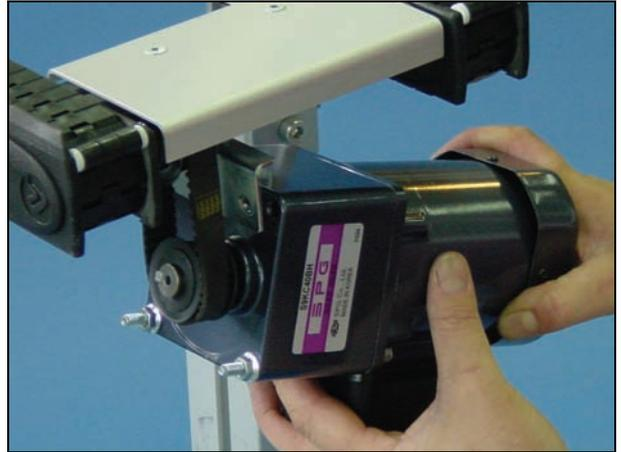
5 安装固定电机的螺丝。
