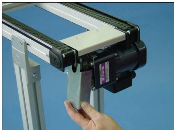
3 使用 3 mm 内六角扳手旋松固定传动装置盖的螺丝，取下传动装置盖和两个定距垫圈。
