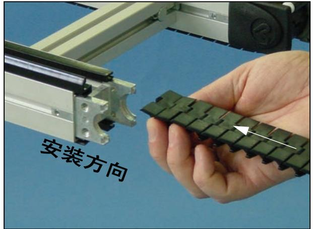
9 将链条穿入传动端并在必要时拉动另一链条来帮助穿入。若另一链条已被卸下，则旋转传动轮。
