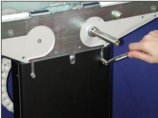
21 将塑料套管安装到传动轴上。
