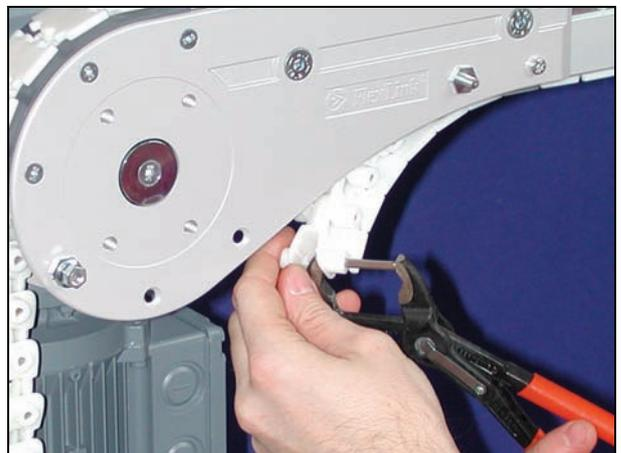
11 将链条端对接。确保保留节球并颠倒重新装配。
