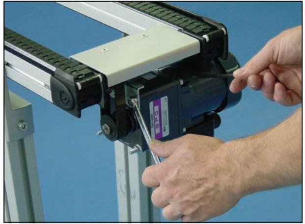
4 旋下固定电机的螺丝。
