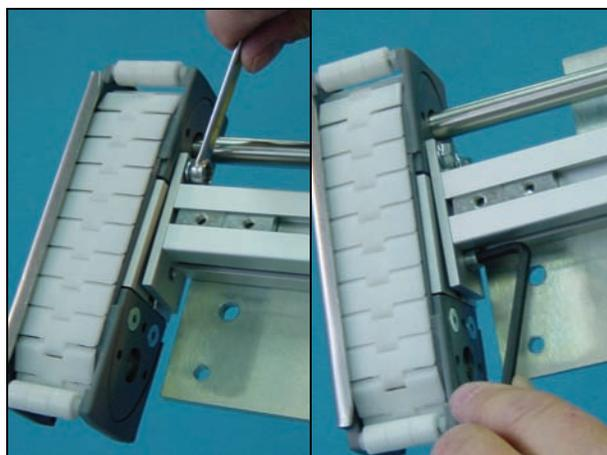
11 安装侧盖和固定侧盖的两颗螺丝，使用 10 mm 套筒扳手。
