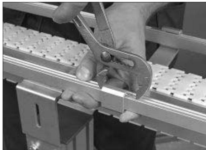
2 Setzen Sie den Federstift zwischen Halter und Seitenführung mit einer Zange ein.
