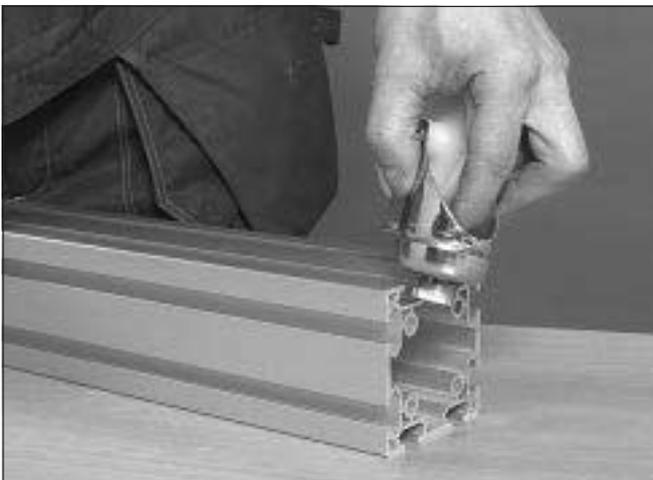
3 Schieben Sie das Transportrad in die T-Nut des Strukturprofils ein.
