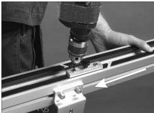
1 Bohren Sie zwei Löcher am Anfang jedes Gleitschienenabschnitts. Verwenden Sie die Bohrvorrichtung um saubere Bohrungen in exakter Position zu erreichen. Die Tabelle gibt die Bohrdurchmesser an.
