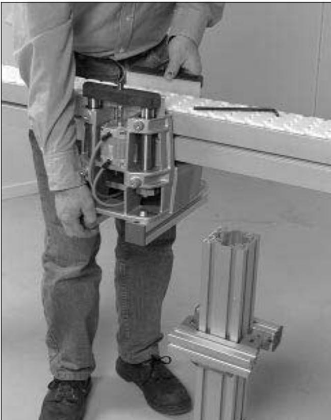
10 Palettenstation anheben und Führungsstifte in die T-Nut einer Seite des Führungsprofils einführen.
