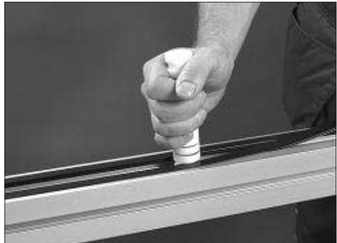
4 Montieren Sie die Gleitschienen sowohl auf der oberen als auch der unteren Profilstelle (ausgenommen bei nur oben laufender Kette).
