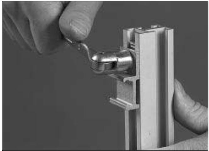
4b Befestigen Sie den Halter XLRC 20 mit Sechskantschraube und Nutmutter.
