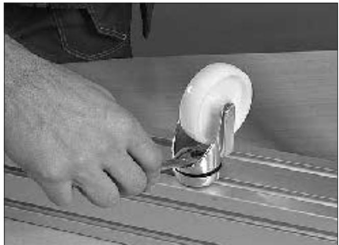
4 Schrauben Sie die Laufrolle mit dem Schraubenschlüssel an das Profil.
