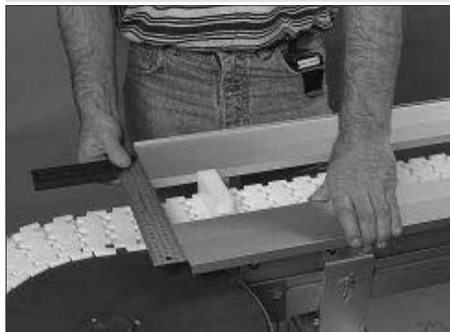
2 Seitenführung auf der gegenüberliegenden Seite des Profils anbringen (parallel mit der ersten Führung).
