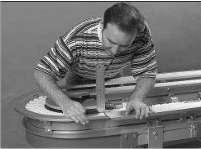
5 Den nächsten geraden Seitenführungsabschnitt montieren: überprüfen, ob die Seitenführung auf die Verbindung des Führungsprofils ausgerichtet ist. Die Befestigungen der Seitenführungshalterungen festziehen.
