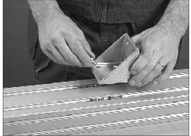
2 Setzen Sie die erforderliche Zahl von Nutmuttern in die T-Nuten des Strukturprofils ein. Befestigen Sie den Stützwinkel mit Schrauben und Unterlegscheiben.
