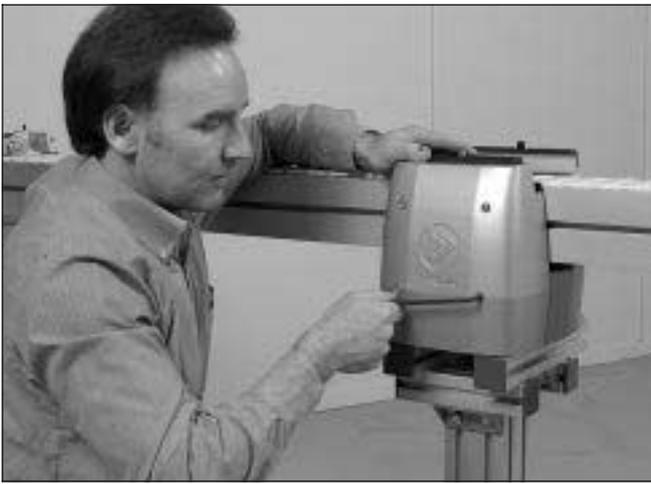
16 Die Abdeckung der Palettenstation wieder montieren.
