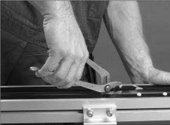
1 Pressen oder schrauben Sie die Schrauben mit einer Zange oder einem Schraubendreher in die Bohrungen ein.
