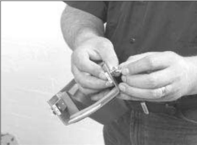
1 Vierkantmuttern an einem Ende der Tropfwanne anbringen und leicht anziehen. (Ein Paar für X\_DC, X\_DD und X\_DE; zwei Paar für X\_DJ und X\_DH.) Tropfwanne auf einen Tropfrinnenabschnitt schieben.
