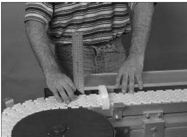
1 Seitenführung auf die korrekte Länge zuschneiden (Länge des entsprechenden Führungsprofils  $\pm 1,0$  mm). Ein Stück gerade Seitenführung montieren. Zur korrekten Positionierung Einstellwinkel und Montagewerkzeug verwenden. Das Ende der Führung auf die Verbindung des Führungsprofils ausrichten. Die Schrauben festziehen.
