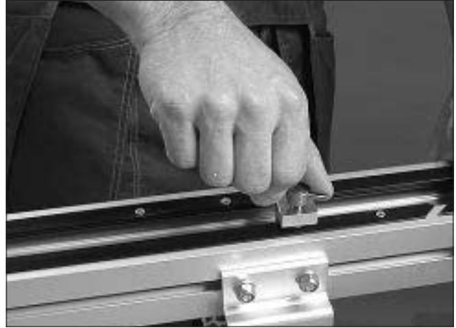
1 Setzen Sie die Nieten in die Bohrungen, verwenden Sie dazu eine Nietzange oder eine Nietklammer. Den Nietentyp entnehmen Sie der Tabelle auf der vorherigen Seite.
