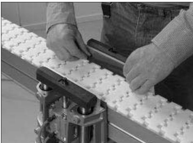
14 Um die Palettenstation zu zentrieren, je ein Distanzstück (2,5 mm stark) auf die beiden Seiten des Profils zwischen die Palettenstation und das Führungsprofil plazieren.
