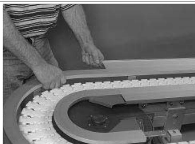
4 Seitenführungen für den inneren und äußeren Bereich des Bogens montieren. Die Seitenführungshalterungen erst festziehen, wenn der nächste gerade Führungsabschnitt montiert und festgezogen ist.
