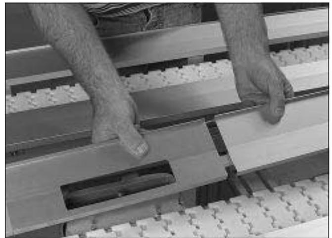
12 Überprüfen, ob der Schlitz in der speziellen Seitenführung für Palettenstationen in Bezug auf die Linie der Palettenstation korrekt positioniert ist.
