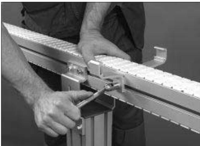
1 Befestigen Sie die Halter entlang dem Kettenfördersystem mit T-Bolzen und Muttern. Der Abstand zwischen den Haltern sollte ca. 0,5 bis 1 m betragen.
