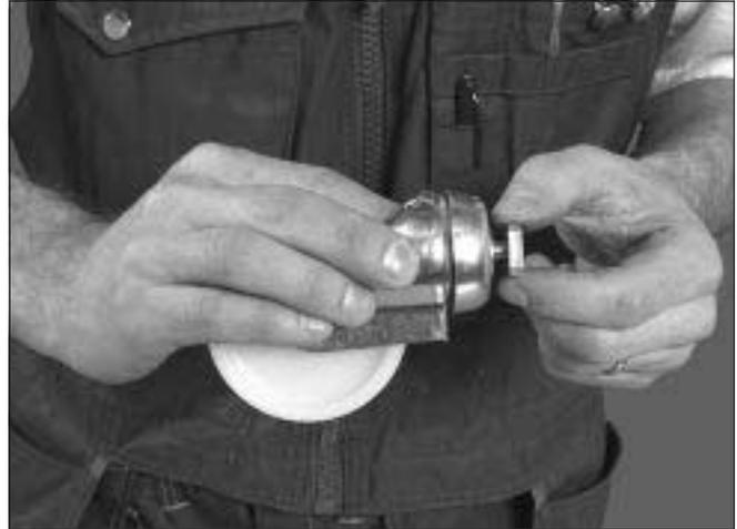
2 Setzen Sie Schraube und Zwischenscheibe in die Gewindebohrung am Laufrollenbügel ein. Verwenden Sie eine Unterlegscheibe mit Nutmutter.
