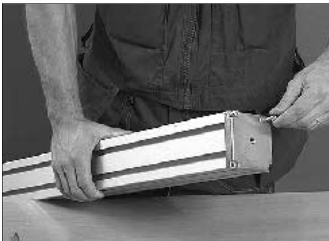
1 Befestigen Sie die Endplatte am Profil mit vier Innensechskantschrauben.
