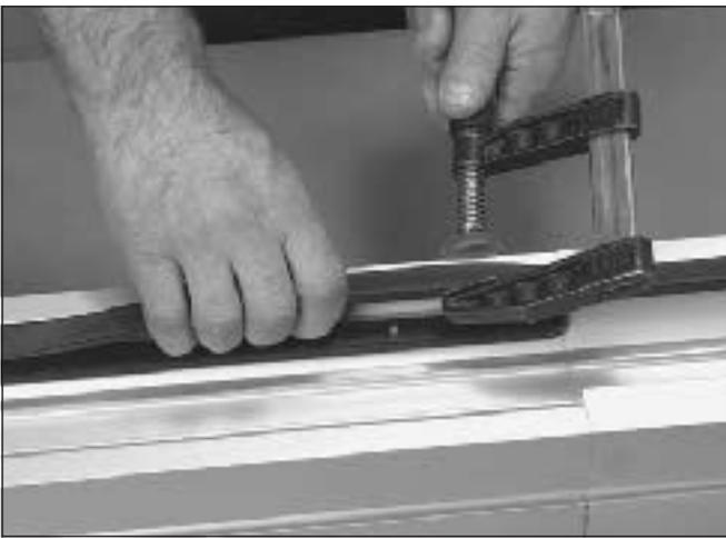
7 Gleitschiene mit einer Zwinde an der Stelle an den Profilflansch klemmen, an der das Profil Typ N beginnt.
