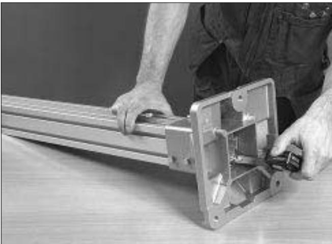
3 Das Führungsprofilende sollte einen Abstand von ca. 50 mm zum Boden des Fußes haben, um bei der Montage eine Höhenverstellung zu ermöglichen.
