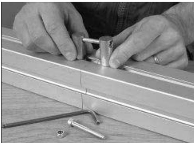
3 Verbinden Sie die beiden Befestigungsbügel mit einer Schraube und einer Mutter. Plazieren Sie die Bügel in die Bohrungen des Profils.
