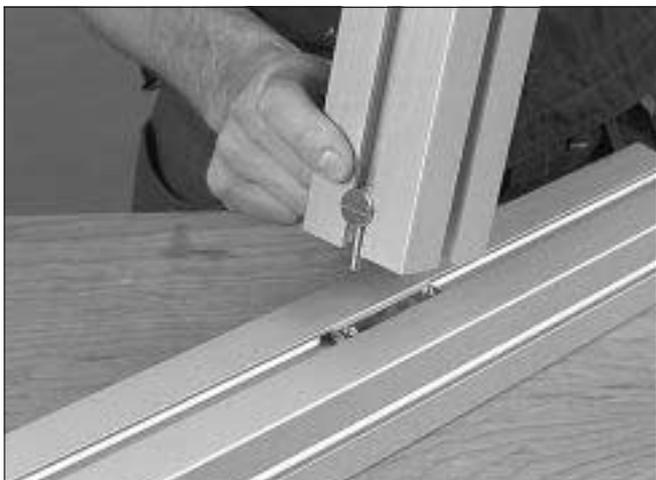
3 Stecken Sie einen Befestigungsbügel in die Bohrung und setzen Sie eine M6x30 Innensechskantschraube an jeder Seite ein. Setzen Sie eine Nutmutter in das Querprofil ein.
