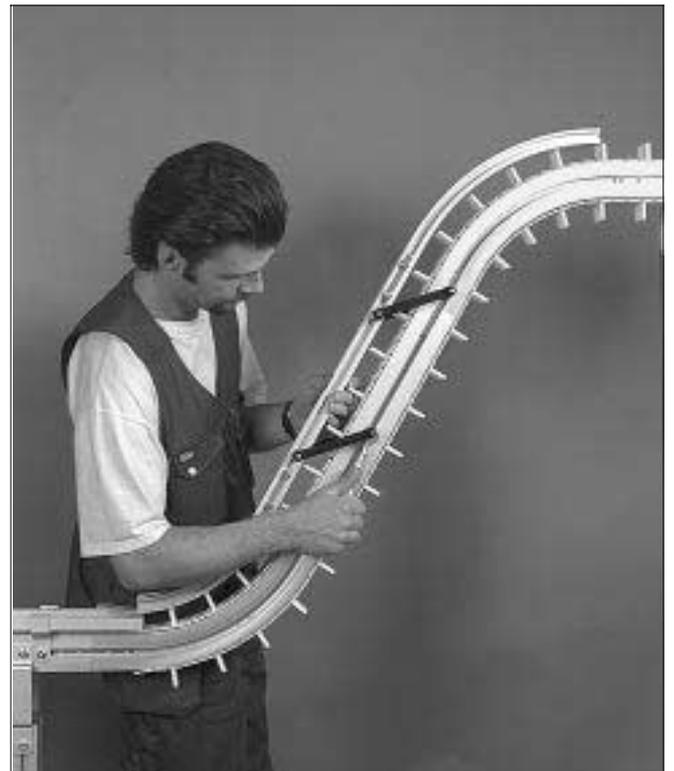
2 Befestigen Sie zwei Stützenpaare an jeder Seite. Zuerst an der Oberführung, dann in der T-Nut des Führungsprofils (Ringschlüssel SW 13 mm).
