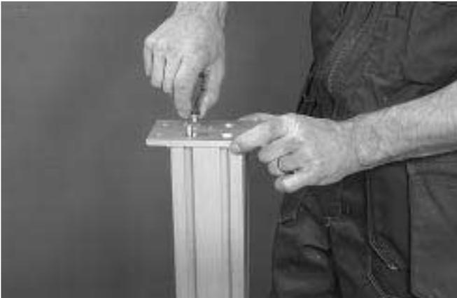
1 Befestigen Sie mit Innensechskantschrauben MF6S 8x30 und Unterlegscheiben ein Anschlußstück am Profilende.
