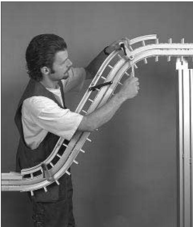
3 Befestigen Sie die Bogenstützen an der Oberführung und an dem Führungsprofil. Bogenstützen werden nur an einer Seite befestigt.
