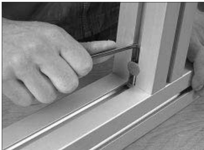
4 Ziehen Sie die Schrauben mit einem Innensechskantschlüssel fest (Das empfohlene Anziehdrehmoment für geschmierte Verbindungselemente beträgt 10 Nm).
