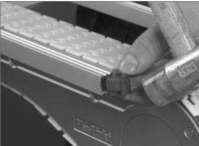
Verschließen Sie alle Profilen mit Endstücken. Verwenden Sie dazu einen Gummihammer.
