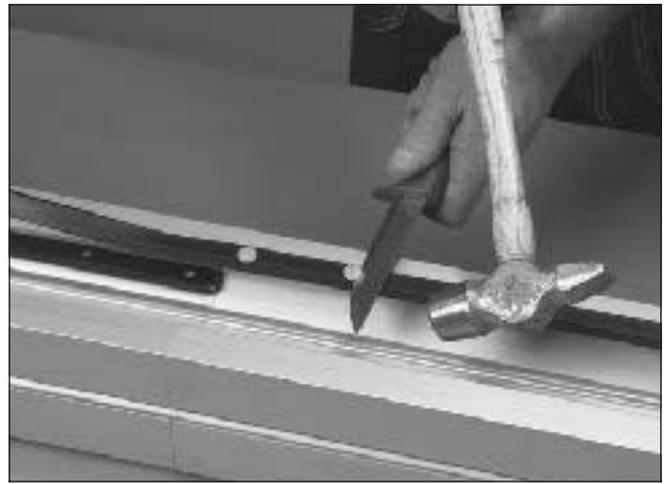
6 Die Schrauben mit einem Schraubenzieher einsetzen. Die Schraubenköpfe mit Messer und Hammer abschneiden. Überstehende Kanten abfeilen. Der Schnitt sollte von der Verbindungsstelle weg in Transportrichtung erfolgen.
