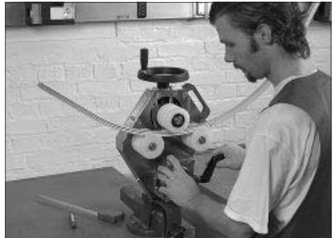
Sind mehrere Bögen mit dem gleichen Radius auszuführen, notieren Sie die Endposition an der Anzeige der oberen Rolle. Sie erhalten damit den korrekten Radius bei allen weiteren Profilen.
