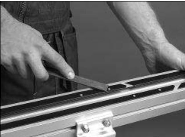
3 Achten Sie darauf, daß die Oberfläche der Gleitschiene eben ist und die Schrauben nicht überstehen. Sollte die Oberfläche uneben sein, feilen Sie die Ecken eben. Überprüfen Sie, ob Kunststoff oder Metall an der Ober- und Unterseite der Gleitschiene übersteht.
