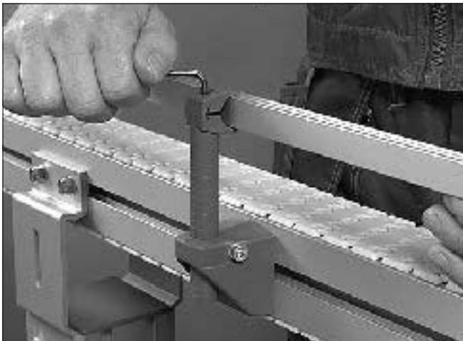
3 Befestigen Sie die Seitenführung an der Klemme. Ziehen Sie die Schraube fest.
