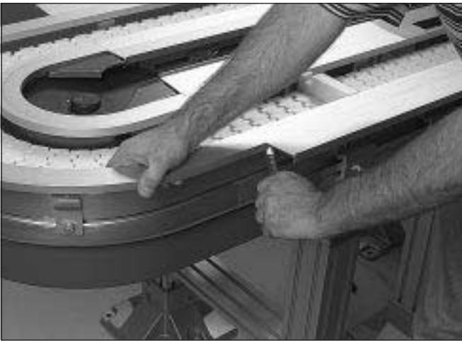
7 Die Position des Bogens justieren und die Verbindungsstreifen sowie die Seitenführungshalterungen festziehen.
