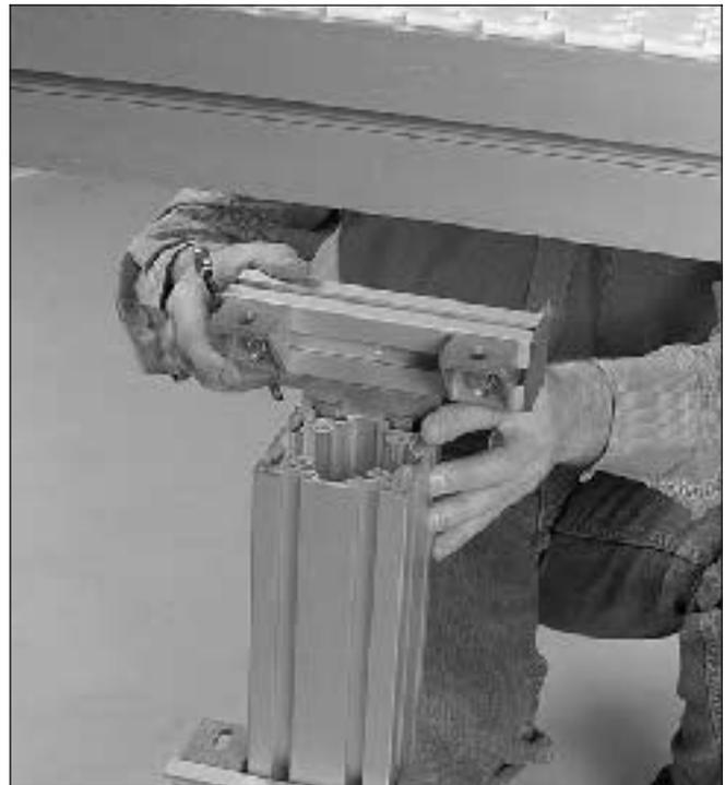
9 In der senkrechten T-Nut Vierkantschrauben einsetzen. Mit Winkelhalterungen kurze XCBM 44 Profile am senkrechten Profil befestigen.
