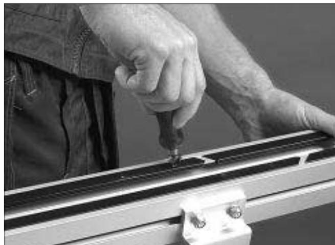
2 Verwenden Sie das Senkwerkzeug, um die Bohrungen zu entgraten und anzusenken. Entfernen Sie alle Metallspäne unter der Gleitschiene.
