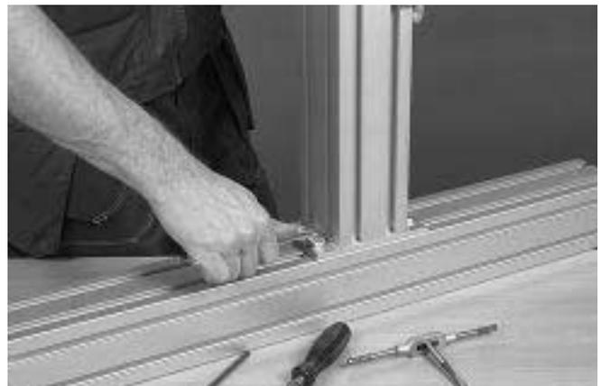
4 Schrauben Sie das Anschlußstück mit Sechskantschrauben M6S 8x16 an das Querprofil.
