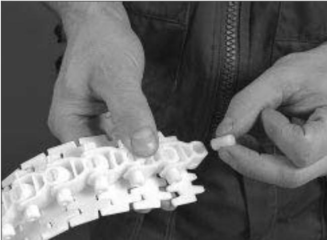
1 Setzen Sie den Kunststoffbolzen mit der Nut nach außen ein.
