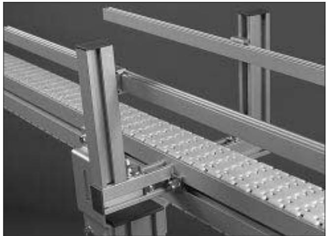
6 Befestigen Sie die Seitenführungen an den Haltern mit Federstiften und einer Zange.
