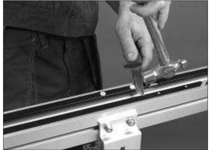
2 Entfernen Sie die Köpfe der Kunststoffschrauben mit Messer und Hammer. Der Schnitt sollte von der Verbindungsstelle weg in Transportrichtung erfolgen.
