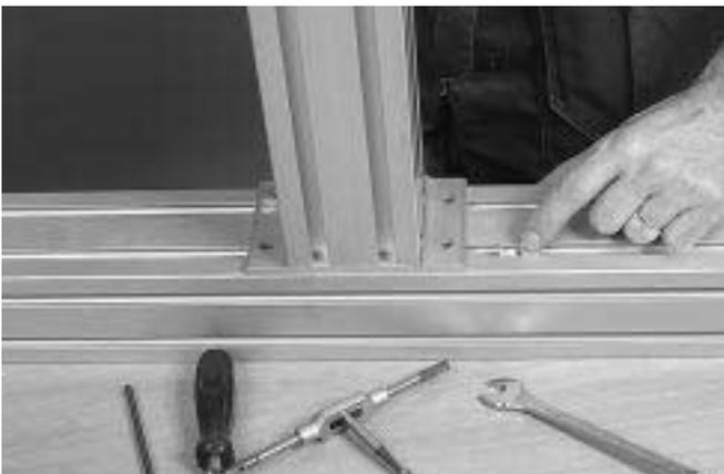
3 Setzen Sie Nutmuttern in die T-Nuten des Querprofils ein.
