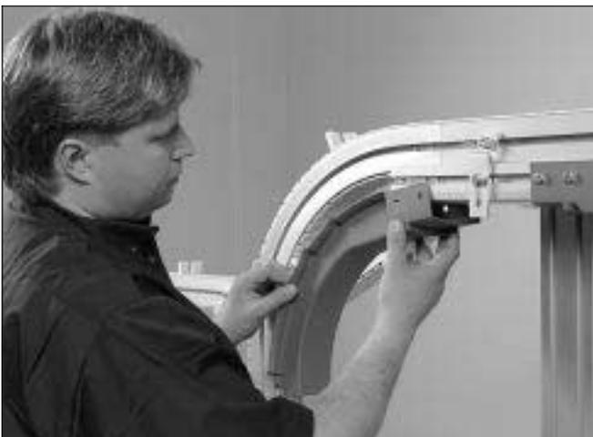
2 Tropfwanne am Profil befestigen. Schrauben nicht ganz festziehen. Sicherstellen, daß die Tropfwanne sich der Kurve des Führungsprofils anpaßt. Ist das nicht der Fall, Tropfwanne so justieren, bis sie sich in der korrekten Position befindet.
