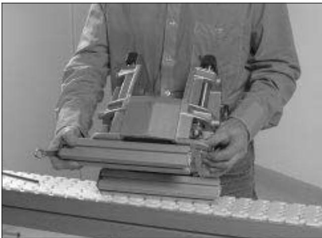
6 Abdeckung der Fixierstation entfernen. Ein Paar Profile XCBM 44 ( $\approx 270$  mm lang) unter der Fixierstation mit M6S 8x20 Schrauben, Unterlegscheiben und XCAN 8 Nutmuttern montieren.
