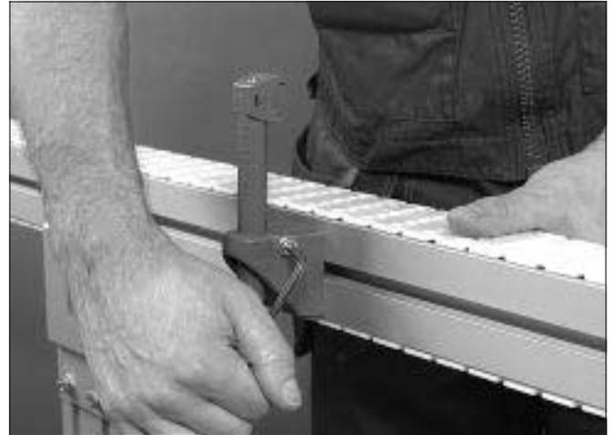
2 Befestigen Sie eine Seitenführungsklemme am Befestigungswinkel. Ziehen Sie die Schraube fest.
