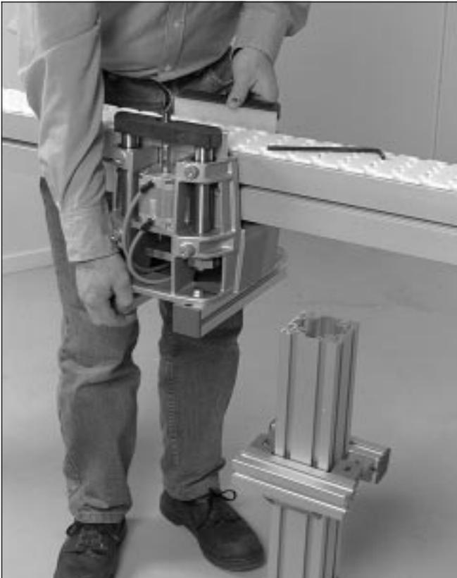
10 Levante la estación de posicionamiento y coloque los pasadores de guía en la ranura en T de un lateral del perfil del transportador.
