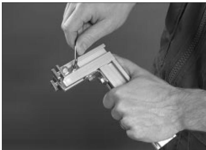
2 Acople dos conectores interiores XMRX 20 al extremo del soporte en L.
