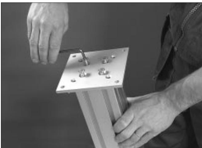
2b En el perfil XCBM 88x88, también se pueden utilizar cuatro tornillos de M8 en el centro de la platina.
