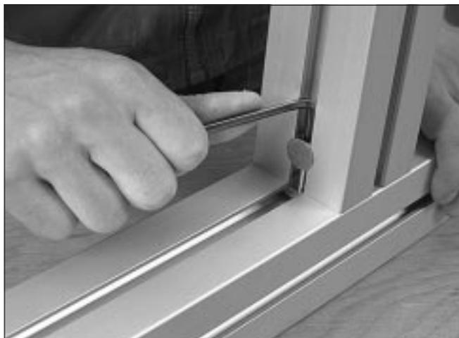
4 Apriete los tornillos utilizando una llave allen. (El par de apriete recomendado para una articulación lubricada es de 10 Nm).
