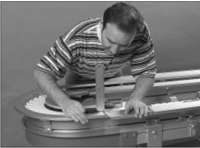
5 Monte el siguiente tramo de perfil guía recto: compruebe que el perfil guía está alineado con la unión del perfil del transportador. Apriete los afianzadores de las bridas de los perfiles guía.
