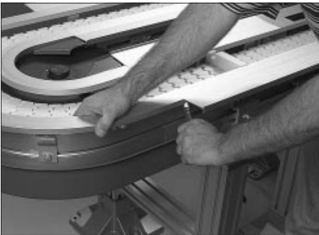
7 Ajuste la posición de la curva y fije las regletas de conexión y las bridas de los perfiles guía.
