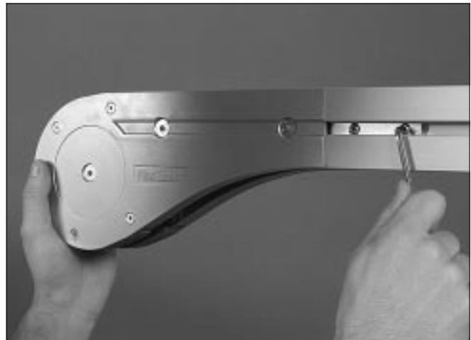
2 Fije la unidad de reenvío al perfil utilizando una llave allen para apretar los tornillos de ajuste.
