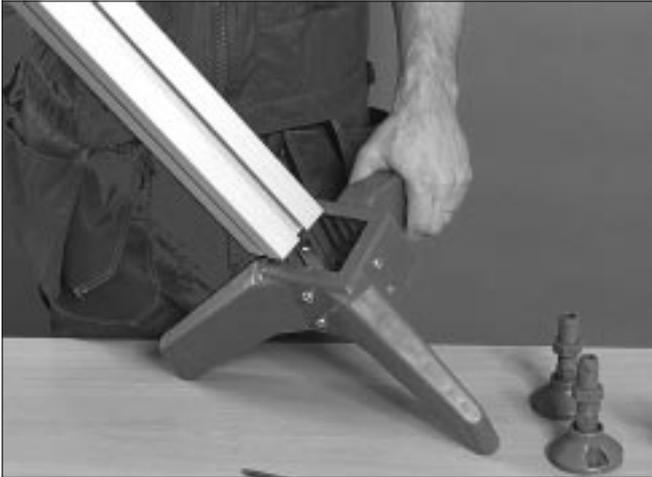
1 Monte el pie en el extremo del perfil deslizando las mordazas de compresión del pie dentro de la ranura en T del perfil.
