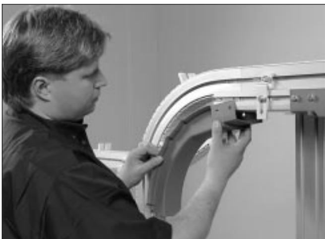
2 Monte la cubeta de goteo en el perfil. No apriete los tornillos totalmente. Compruebe que la cubeta de goteo sigue la curva del perfil del transportador. En caso contrario, ajuste la posición de la cubeta hasta conseguirlo.
