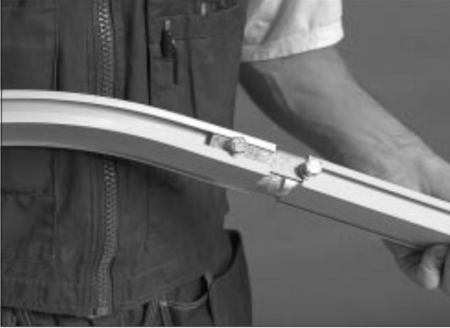
1 Conecte la pieza recta y las curvas utilizando las regletas de conexión que se incluyen.
