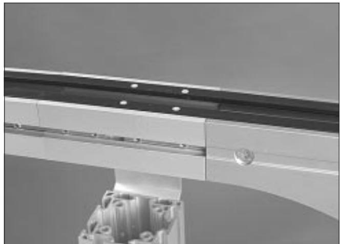
4 Mantenga una distancia de aproximadamente 30 mm entre los remaches y la unidad de reenvío. Esto se realiza para poder desmontar la unidad de reenvío después del montaje del transportador.
