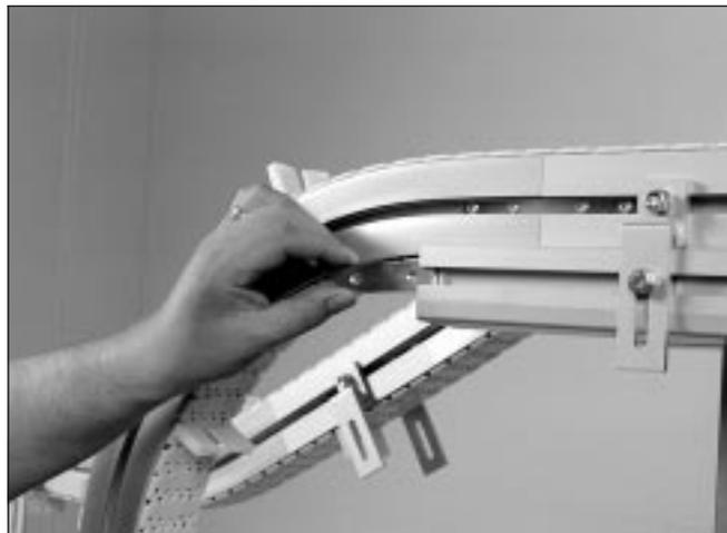
1b Si hay una curva de 90°, introduzca las tuercas cuadradas directamente en la ranura en T del perfil del transportador.
