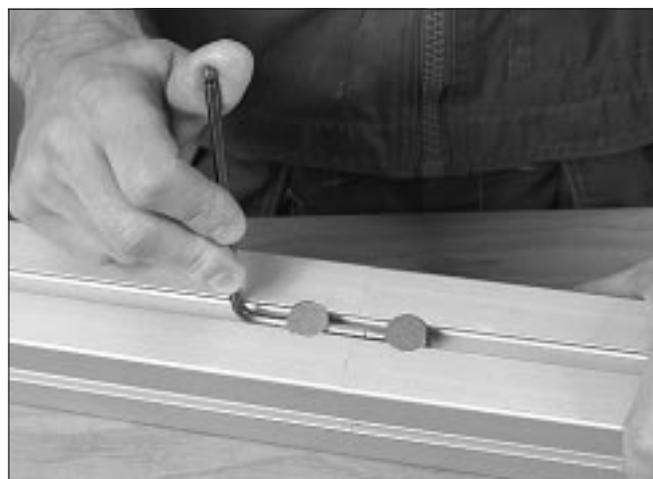
4 Conecte las horquillas situadas en el otro lado del perfil. Apriete ambos tornillos.
