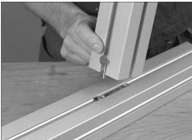
3 Coloque una horquilla de fijación en el orificio e introduzca un tornillo de cabeza hexagonal de 6x30 en cada lado. Introduzca una tuerca almenada en el perfil transversal.
