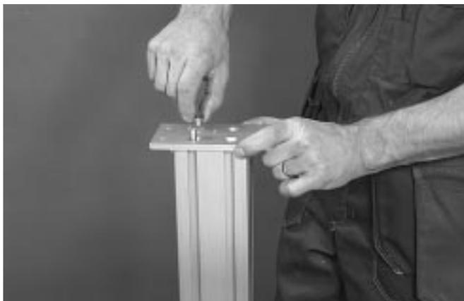
1 Acople una platina de montaje al extremo del perfil utilizando tornillos allen MF6S 8x30 y arandelas.
