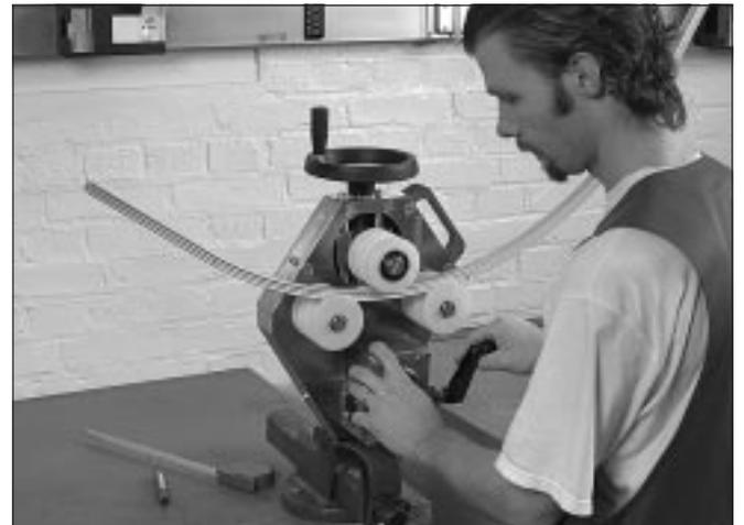
Si se han de realizar múltiples curvas con el mismo radio, observe la posición final de la escala indicadora de la rueda superior para garantizar que los perfiles subsiguientes tengan el radio correcto.
