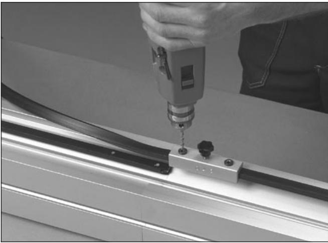
5 En la pestaña superior del raíl de deslizamiento, use el útil de taladrado para practicar dos orificios en el raíl de deslizamiento antes de su introducción en el perfil XKCB N.
