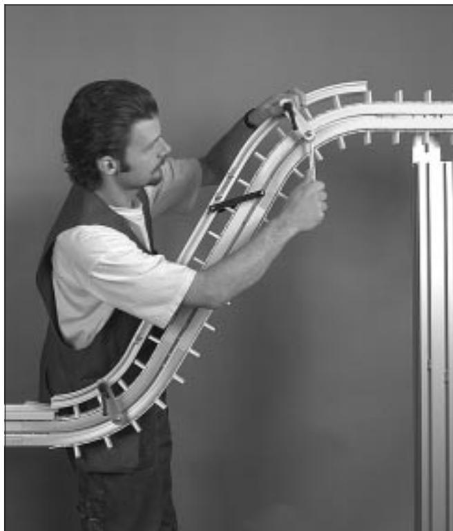
3 Acople los soportes para curvas y el dispositivo de fijación a la pieza frontal y al perfil del transportador. Los soportes para curvas se montan únicamente en un lado.
