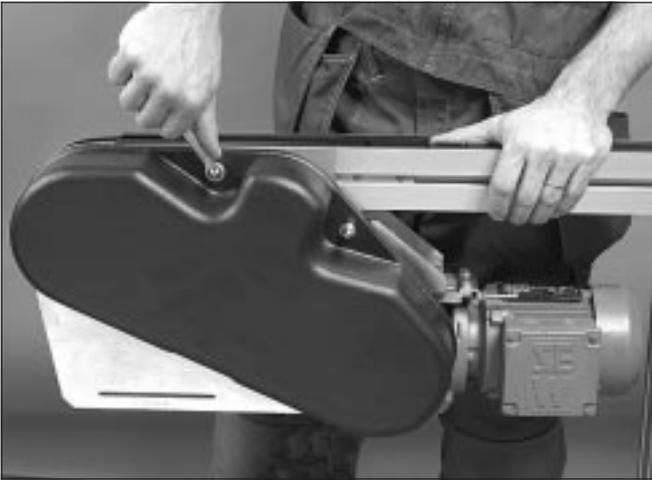
1 Retire la cubierta protectora de la transmisión de la unidad de tracción.
