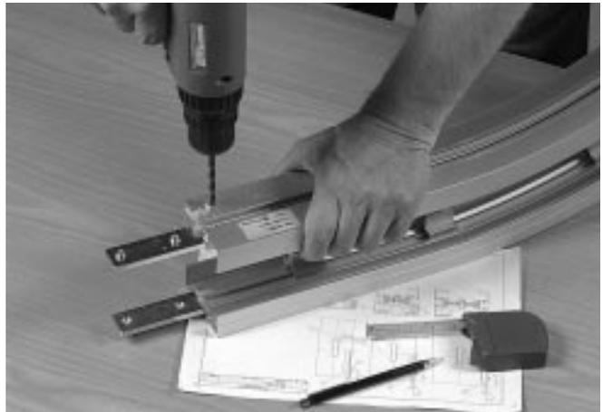
4 Taladre un orificio en el extremo inicial (en la dirección de desplazamiento) de la curva interior utilizando una broca de 4,2 mm. Deje una distancia de 20 mm entre el orificio y el extremo del perfil. Desbarbe el orificio.
