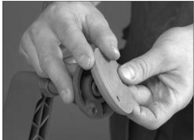
2 Los amortiguadores de vibraciones se ajustan a presión en la parte inferior de los elementos de ajuste.
