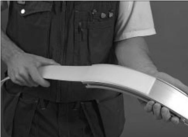
1 Deslice la banda dentro de la ranura del lado interior de la pieza frontal, antes de montar la misma en el perfil del transportador.
