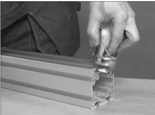
3 Deslice el pie dentro de la ranura en T del perfil estructural.
