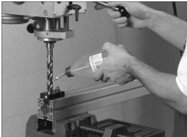
2 Utilice un útil de taladrado XCAD 18 para taladrar un orificio de 18,25 mm en el extremo del perfil. Mientras el taladro se realiza en aluminio, asegúrese de lubricar la broca con alcohol metílico.
