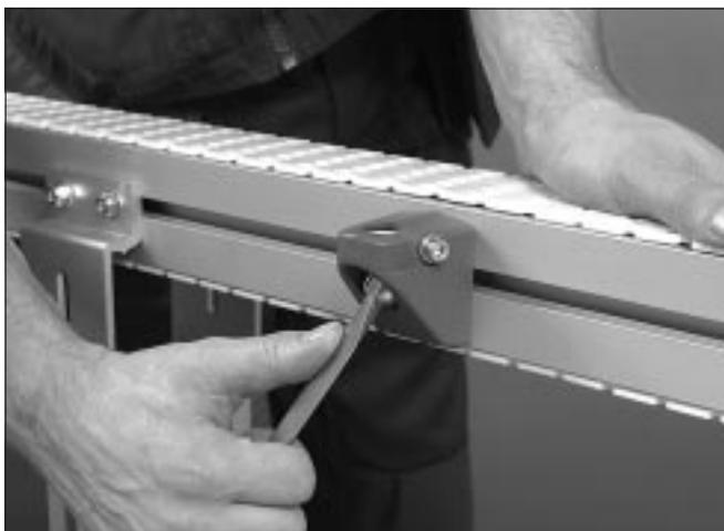
1 Fije un soporte de escuadra de perfil guía al perfil del transportador utilizando el tornillo con cabeza en T, la tuerca y la arandela.
