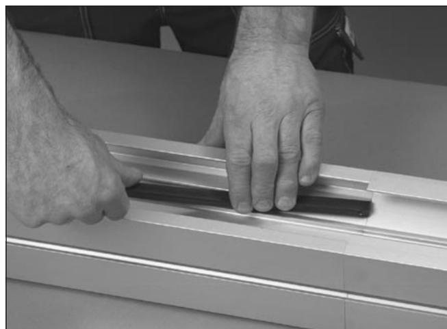
2 Monte el raíl de deslizamiento en la pestaña inferior del perfil del transportador.
