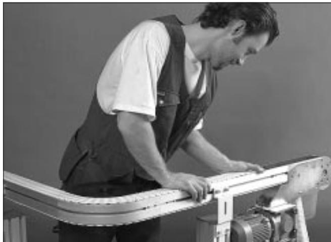
2 Haga avanzar la cadena a lo largo del transportador tirando de la misma a través de la unidad de envío, y tirando hacia atrás en el lado de retorno hasta la unidad de tracción.
