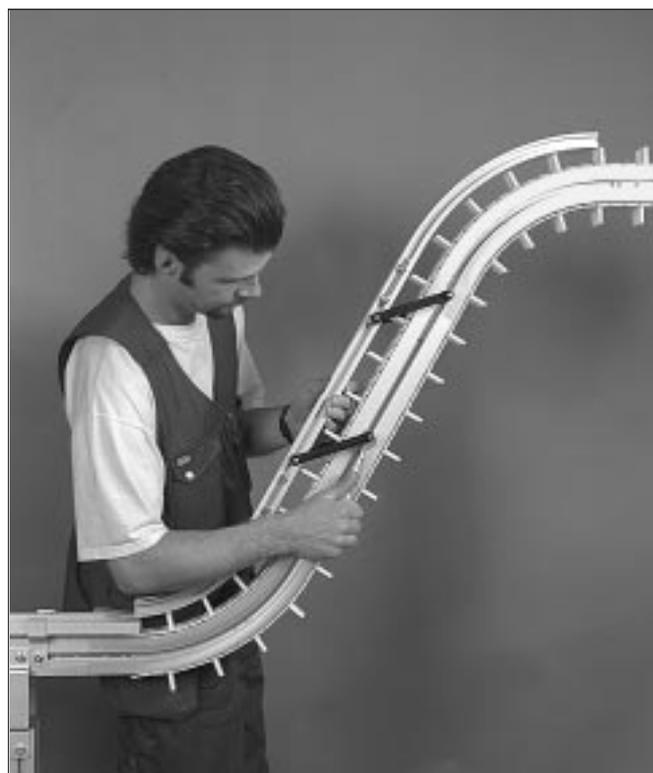
2 Acople los pares de soporte, dos a cada lado, primero a la pieza frontal y, a continuación, al perfil del transportador con ranura en T, utilizando una llave de 13 mm.
