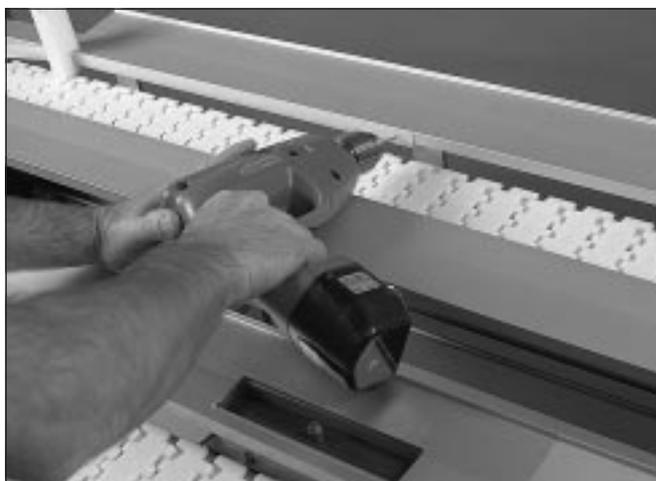
9 Taladre dos orificios en el raíl de deslizamiento y fíjelo con tornillos de plástico.
