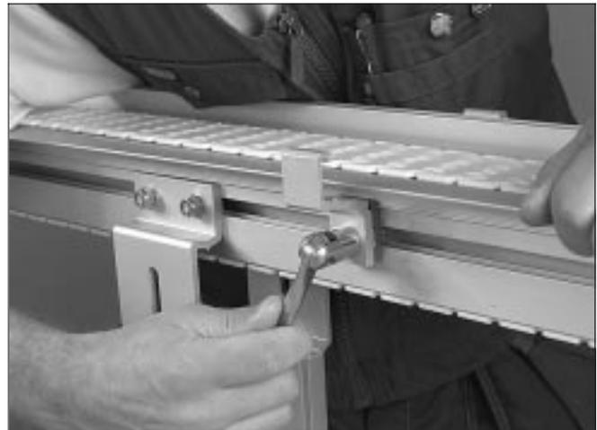
Sistema transportador XL: Además de las bridas para perfiles guía, se pueden utilizar distanciadores XLRD 6 P para fijar platinas angulares.
