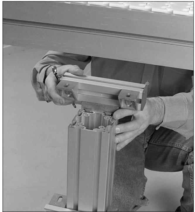
9 Introduzca tuercas cuadradas en las ranuras en T del perfil vertical. Utilice escuadras para montar secciones cortas de perfil XCBM 44 en el perfil vertical.
