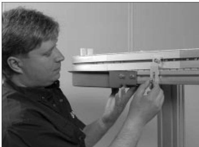
1 Utilice los tornillos con cabeza en T, las tuercas y las arandelas para conectar las bridas para bandejas de goteo a la ranura en T del perfil del transportador.
