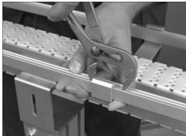
2 Utilice los alicates para introducir un pasador elástico entre la brida para el perfil guía y el perfil guía.
