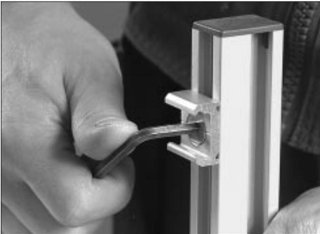
4a Acople la brida para perfiles guía XLRC 20 A utilizando una tuerca almenada y una llave allen.
