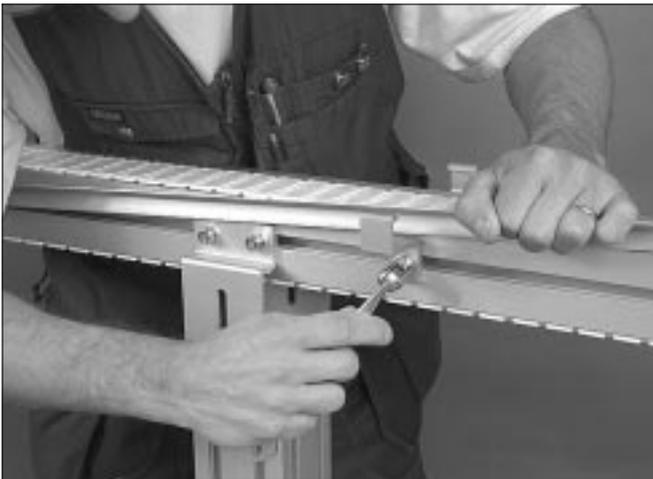
Acople las bridas para perfiles guía al perfil del transportador sin apretar las tuercas. Fije la platina angular introduciendo la misma en la ranura practicada en el lateral de la brida para perfiles guía. Apriete los tornillos.
