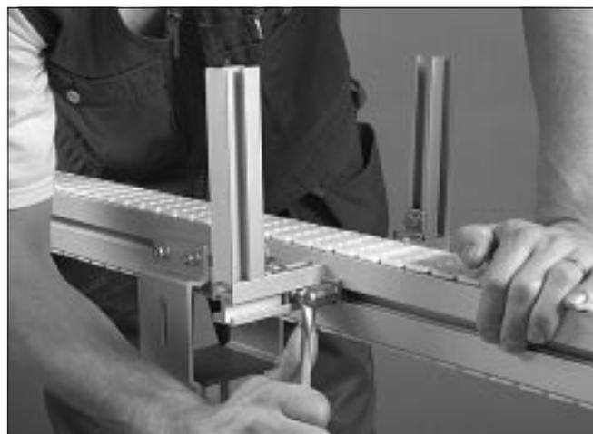
3 Monte el soporte en el perfil del transportador utilizando tornillos con cabeza en T, tuercas y arandelas.
