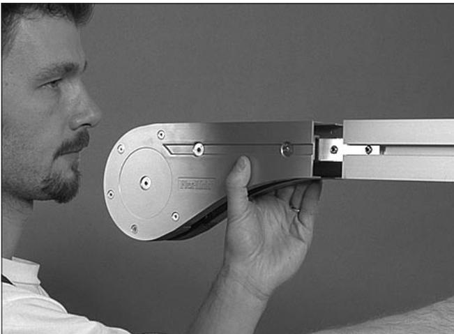
1 Introduzca las regletas de conexión de la unidad de reenvío en las ranuras en T del extremo del perfil.
