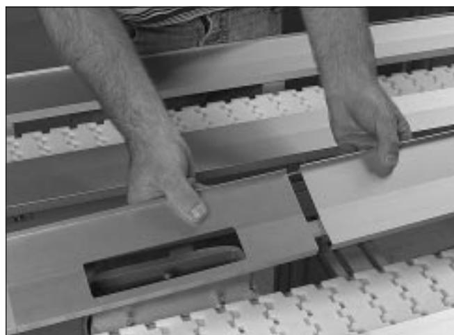
12 Compruebe que la ranura del tramo de perfil guía especial de la estación de posicionamiento está colocada correctamente comparando la posición con la de las reglas de la estación de posicionamiento.
