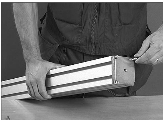
1 Acople la platina terminal al perfil introduciendo cuatro tornillos allen en los orificios practicados en la platina terminal.
