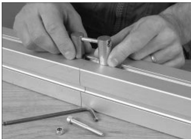
3 Conecte las dos horquillas de fijación con un tornillo y una tuerca. Coloque las horquillas en los orificios de los perfiles.
