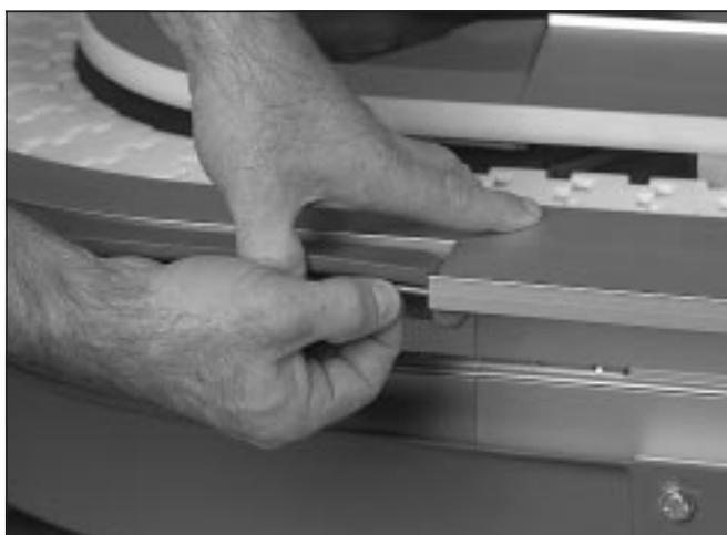
11 Monte el recogedor de goteo exterior en la curva. Monte los tornillos sin cabeza a modo de pasadores de guía.
