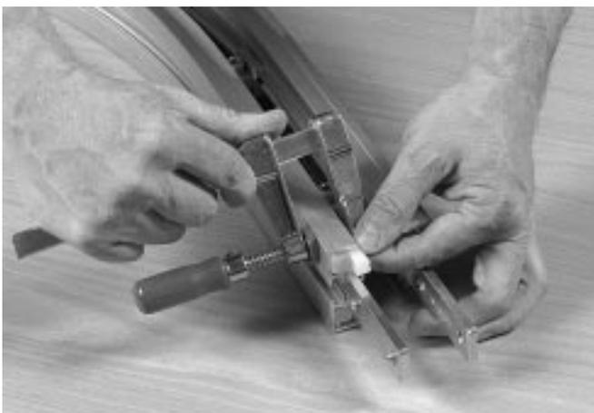
5 Sujete con mordaza el raíl de soporte para garantizar un montaje correcto. Inserte un tramo corto de raíl entre la mordaza y el raíl de soporte para conseguir una fijación firme. Repita el procedimiento en toda la curva.
