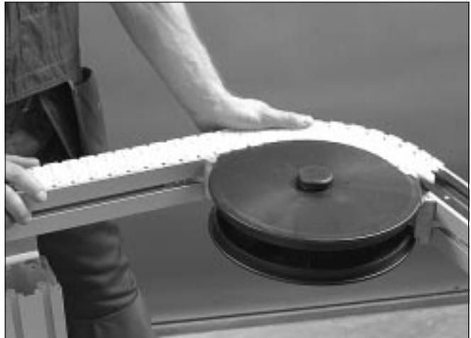
4 Antes del montaje, desplace un tramo corto de cadena (0,5 m) a lo largo del transportador para garantizar un funcionamiento suave del sistema. Si se encuentra alguna obstrucción, debe eliminarse, y repetirse el proceso de comprobación.
