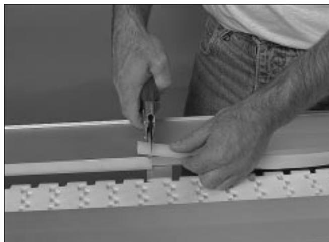
10 Instale el raíl de deslizamiento restante utilizando la herramienta de montaje. Corte el raíl de deslizamiento de modo que todas las uniones queden uniformes (no corte los raíles en ángulo).
