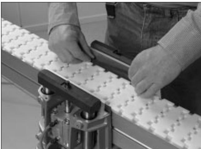
14 Coloque dos piezas distanciadoras (2,5 mm de espesor) entre la estación de posicionamiento y el perfil del transportador, una a cada lado del perfil, para mantener centrada la estación de posicionamiento.
