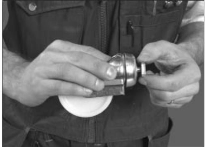
2 Introduzca el tornillo y la arandela de relleno en el orificio para tornillos situado en la horquilla para rueda giratoria.
