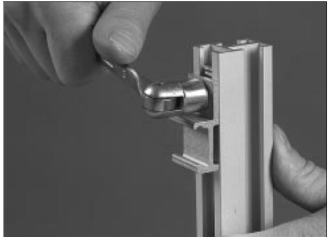
4b Acople la brida para perfiles guía XLRC 20 utilizando un tornillo de cabeza hexagonal y una tuerca almenada.
