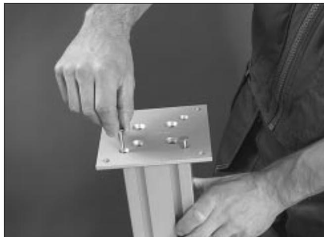
2a Monte la platina de pie en un perfil de soporte XCBL 88x88 mm utilizando cuatro tornillos de M6 en las esquinas de la platina.
