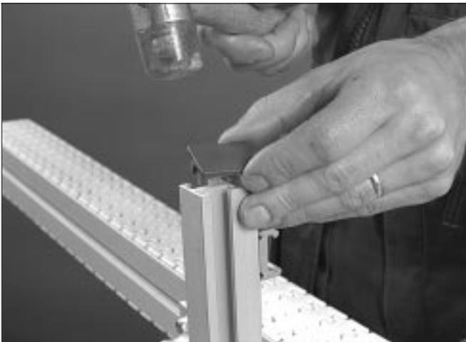
5 Fije las tapas en los extremos de todos los perfiles utilizando un martillo de plástico.
