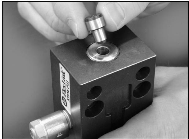
2 Mit einem Hammer mit weicher Schlagfläche den Stift vorsichtig bis zum Anschlag einschlagen.
