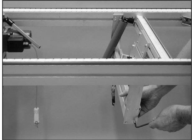
9 Verbinden Sie nun die beiden Hälften der Transfereinheit, indem Sie die teleskopische Welle zusammenfügen. Vergessen Sie nicht die Buchse der Antriebswelle auf der Motorseite der Transfereinheit zu montieren.
