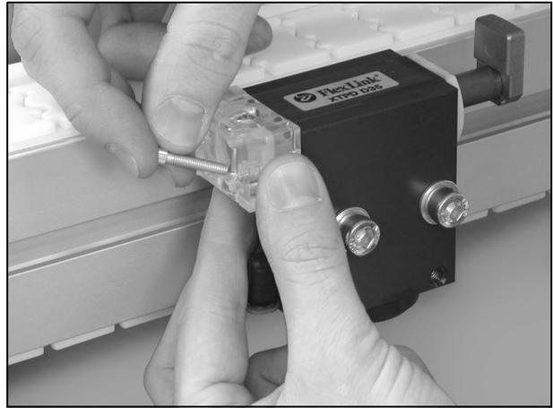
4 Sensor in die Sensorhalterung einsetzen.
