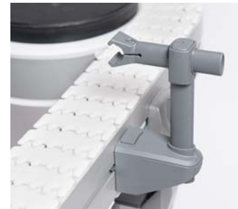
4. Seitenführungsprofil fertig montiert.
