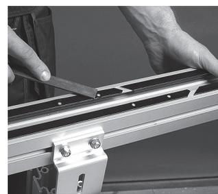
Überprüfen Sie die Ober- und Unterseite der Gleitschiene auf überstehenden Kunststoff oder Schrauben.
