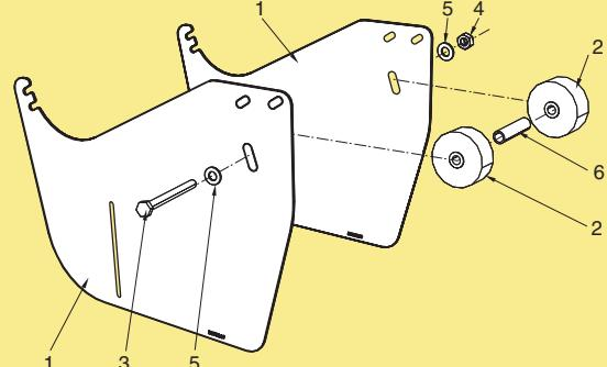
Zubehörsatz für End-Antriebseinheit, Direkt-Antrieb **5058269**
