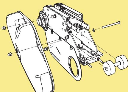
Verwenden Sie die vorhandenen Bohrungen in den Seitenplatten der Antriebseinheit, und montieren Sie das im Umrüstungssatz enthaltene Material entsprechend den oben gezeigten Abbildungen. Stellen Sie nach der Montage die Position der Rollen ein.
