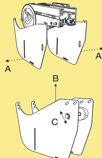
Der vorhandene Durchhangschutz (A) muss entfernt und durch neue Teile (B) ersetzt werden, die im Umrüstungssatz enthalten sind. Stellen Sie nach der Montage die Position der Rollen ein (C).
