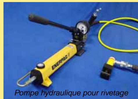
Pompe hydraulique pour rivetage
