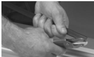
2 Monte el raíl de deslizamiento en la brida inferior del perfil del transportador.
