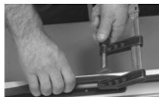
8 Perfore un orificio adicional en cada raíl de deslizamiento, al principio de la sección de perfil tipo N.
