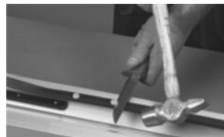
7 Utilice mordazas para presionar el raíl de deslizamiento en la brida del perfil donde empieza el perfil tipo N.
