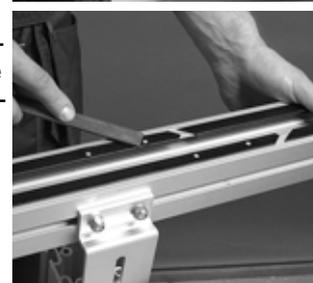
Compruebe la existencia de protuberancias plásticas o metálicas tanto en la superficie superior como en la inferior del raíl de deslizamiento.
