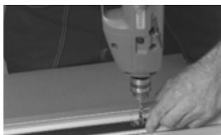
4 Utilice un destornillador para insertar los tornillos. Corte las cabezas de los tornillos con un cuchillo y un martillo. Lime los bordes que sobresalen.
