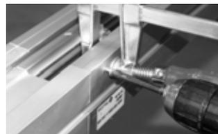
**Fijación del raíl de deslizamiento**
