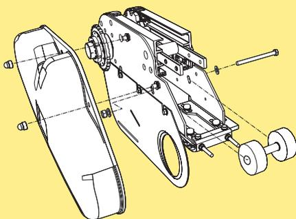
Utilice los orificios existentes en las placas laterales de la unidad de tracción y monte el material en el juego de reconstrucción de acuerdo a las imágenes anteriores. Después del montaje, ajuste la posición de los rodillos.
