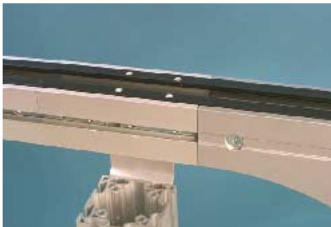
4 ネジとアイドラ端の間には、約 30 mm の間隔を空けてください。アイドラを動かす必要がある場合があります。
