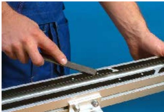
3 スライドレールの表面の傷や樹脂ネジのはみ出しに注意してください。ネジの頭が飛び出ているときはヤスリで落とします。
