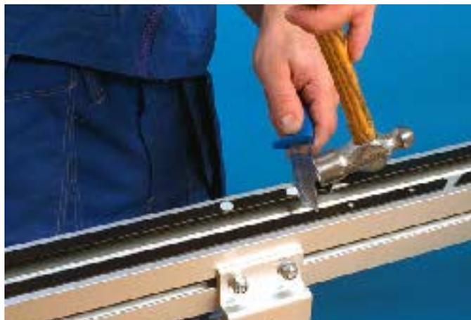
2 ネジの頭をナイフで落とします。落とす方向は、常にチェーンの進行方向です。
