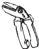
Рис.1 Ножницы с одним лезвием
