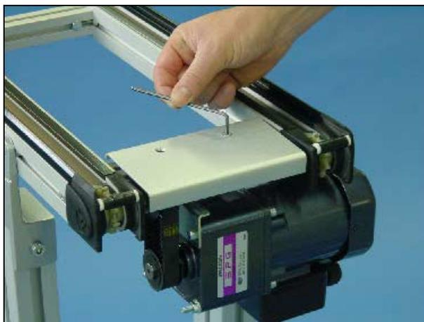
4 Desatarraxe os parafusos do lado externo do Unidade de tração, use a chave Allen de 3 mm.
