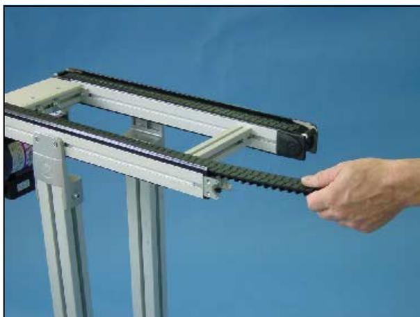
8 Note que a corrente só pode ser montada em uma direção, mesmo que ela seja bidirecional. A corrente deve sempre ser montada na direção de acordo com a figura, sobre o perfil do módulo de retorno para o Unidade de tração.
