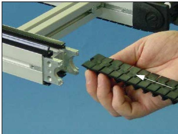
9 Coloque a corrente no Unidade de tração e se necessário ajude a encaixá-la puxando a outra corrente. Se a outra corrente for removida, gire a engrenagem motriz.
