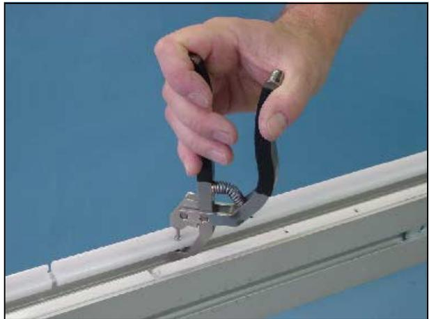
11 Verifique se os rebites não sobressaem a superfície da guia de deslizamento. Verifique tanto a superfície superior e inferior da guia de deslizamento a fim de evitar metais sobressalentes.
