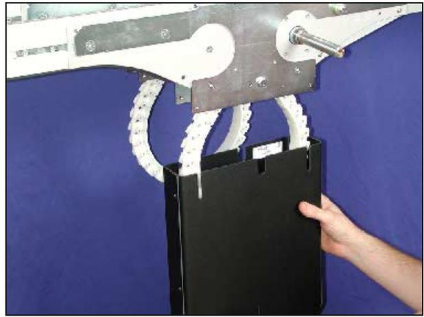
20 Encaixe e aperte os parafusos (4×M6). Use a chave estrela de 10 mm.
