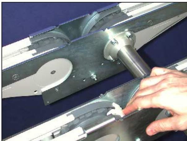
13 Coloque a corrente no transportador até que ela alcance a engrenagem motriz do Unidade de tração.
