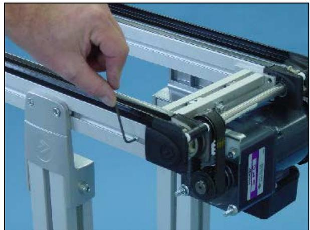
11 Coloque as arruelas e encaixe a cobertura do Unidade de tração.
