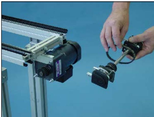
8 Enganche a correia dentada no motor e cuidadosamente monte o Unidade de tração final de volta ao transportador.
