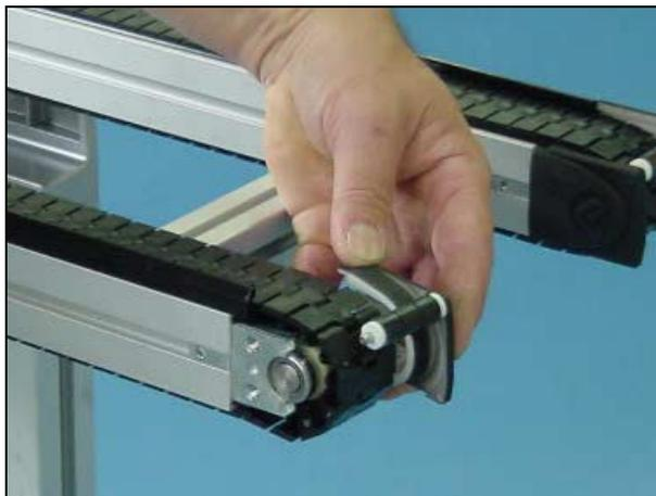
5 Remova um pino (segurando a corrente junto) no módulo de retorno pressionando-o contra a corrente. Use a Chave Allen de 2,5 mm.
