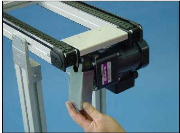
14 Encaixe e aperte os parafusos na correia dentada, use a chave estrela de 8 mm.
