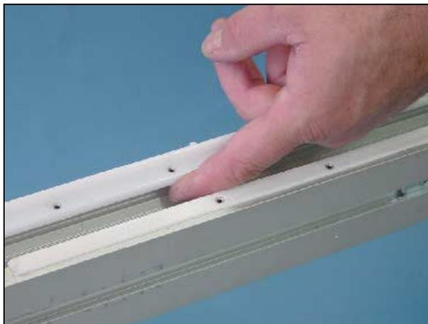
12 Quando você alcançar o fim, corte a guia de deslizamento para que haja uma distância de 4 mm entre a próxima guia de deslizamento.
