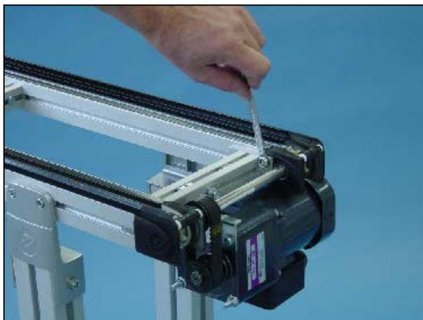
6 Remova cuidadosamente o Unidade de tração final e destrave a correia dentada do motor.
