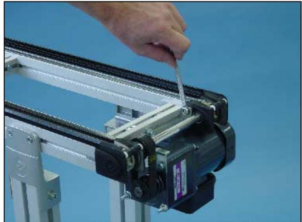
10 Aperte os parafusos no lado externo do Unidade de tração, use a chave Allen de 3 mm.
