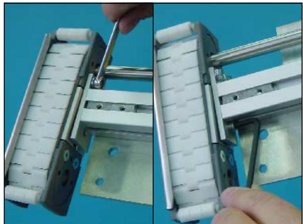
11 Encaixe a tampa lateral e os dois parafusos segurando a tampa lateral, use a chave estrela de 10 mm.
