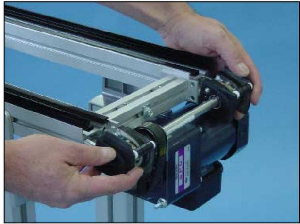
9 Encaixe e aperte os parafusos no lado interno do Unidade de tração, use a chave estrela de 8 mm.
