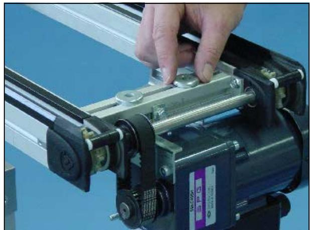
12 Encaixe e aperte os parafusos segurando a cobertura do Unidade de tração, use a Chave Allen de 3mm.
