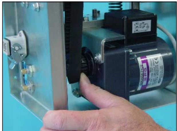
15 Encaixe os parafusos (2×) segurando o módulo transportador. Use a chave Allende 5 mm.
