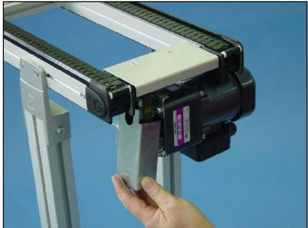
14 Setzen Sie die Schrauben an der Abdeckung des Antriebsriemens ein und ziehen sie diese mit dem 8 mm Ringschlüssel fest.
