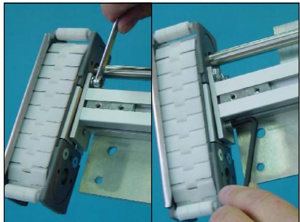
11 Setzen Sie die Seiten-Abdeckung und die beiden Schrauben, die die Abdeckung halten ein und ziehen sie mit dem 10 mm Ringschlüssel fest.
