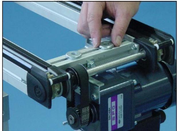
12 Setzen Sie die Schrauben ein, die die Abdeckung der Antriebseinheit halten und ziehen sie mit dem 3 mm Innensechskantschlüssel fest.
