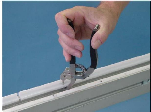
11 Versichern Sie sich, dass die Niete nicht über die Gleitschienen-Oberfläche herausragen. Überprüfen Sie dabei die Oberseite und die Unterseite der Gleitschienen nach überstehendem Metall.
