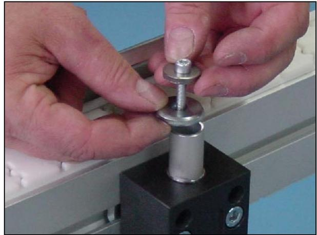
6 Ziehen Sie die Schraube (A) solange mit dem 4 mm Innensechskantschlüssel an, bis der Führungsstift abnehmbar ist.
