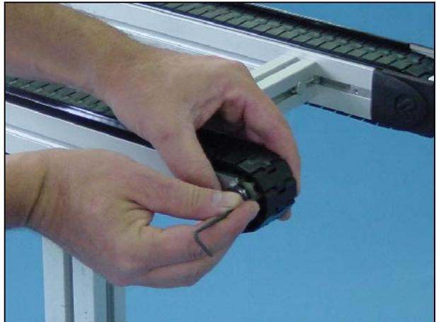
6 Entfernen Sie das Umlenkrad.
