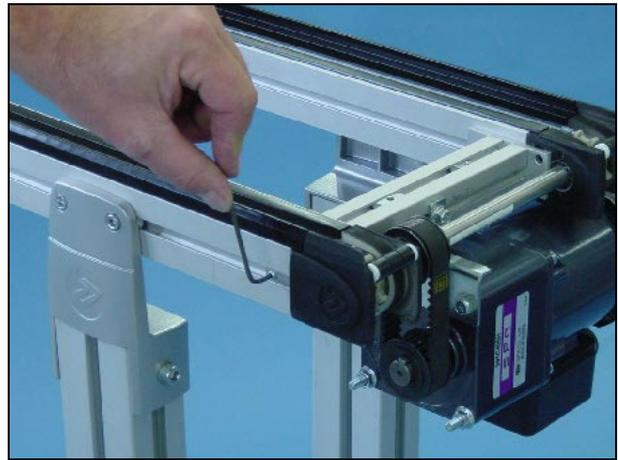
5 Entfernen Sie die Schrauben (4x) auf der inne-
