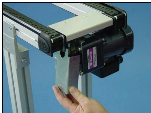
3 旋松固定电机的螺丝，使用 5 mm 内六角扳手和 10 mm 套筒扳手。
