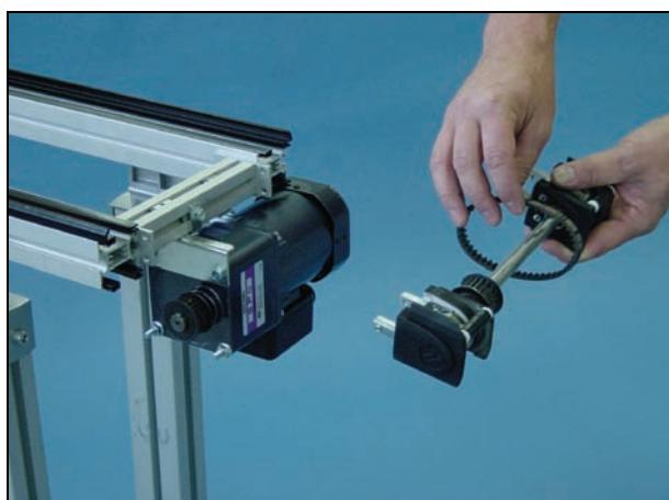
8 将传动皮带在电机上挂起，谨慎将端部传动装置装回传输系统。
