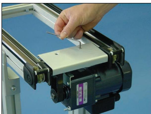
4 旋松传动装置外侧的螺丝，使用 3 mm 内六角扳手。
