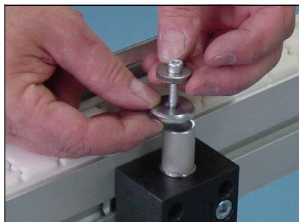
6 旋紧螺丝 (A) 直到定位销松弛。使用 4 mm 内六角扳手。
