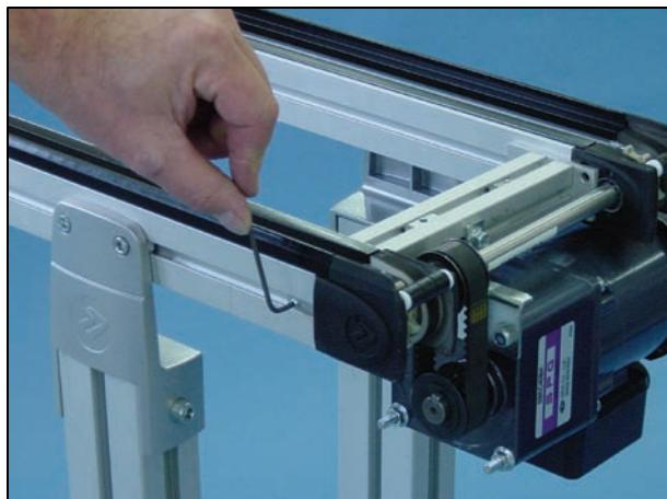
5 取下传动装置内侧的螺丝（4 颗），使用 8 mm 套筒扳手。
