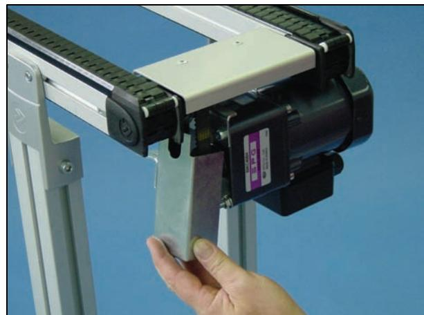
8 安装并旋紧固定传动皮带盖的螺丝。使用 8 mm 套筒扳手。
