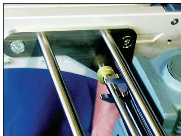
6 将长轴插入距离电机最远的内侧板。将扣环置于轴上并连接轴和电机。
