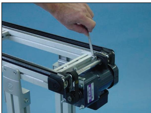
6 谨慎卸下端部传动装置，并将传动皮带从电机取下。
