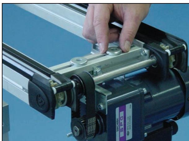
12 安装并旋紧固定传动装置盖的螺丝，使用 3 mm 内六角扳手。
