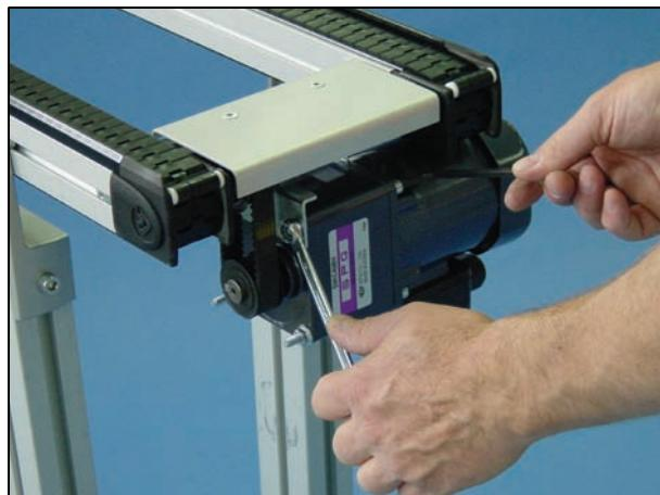
4 旋下固定电机的螺丝。
