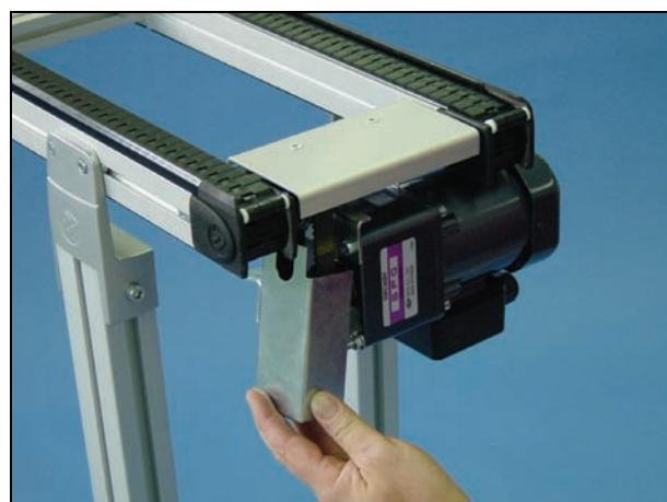
14 安装并旋紧皮带盖上的螺丝，使用 8 mm 套筒扳手。
