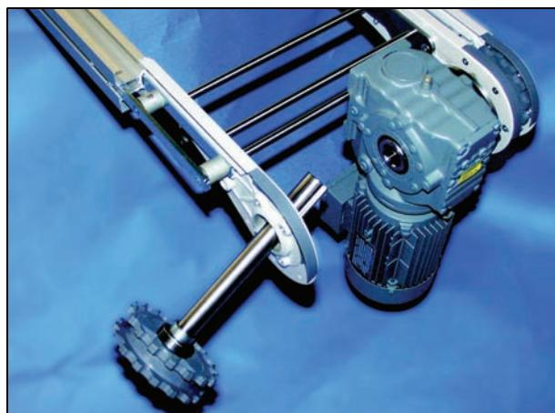
4 调节轴上的键槽使其能与电机齿轮箱上的键槽相啮合。
