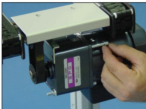
6 旋紧固定电机的螺丝，使用 5 mm 内六角扳手和 10 mm 套筒扳手。
