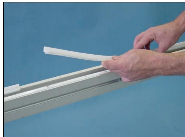
4 使用标记器在横梁底部标记所有旧铆钉孔。
