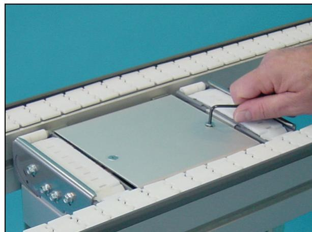
17 安装并旋紧两端的传输装置盖和螺丝（8 颗）。使用十字螺丝刀。
