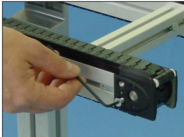
3 谨慎取下塑料导向器。先将其向前推 (1) 然后将端拉出 (2)。
