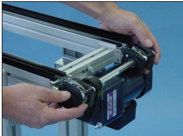
9 安装并旋紧传动装置内侧的螺丝，使用 8 mm 套筒扳手。
