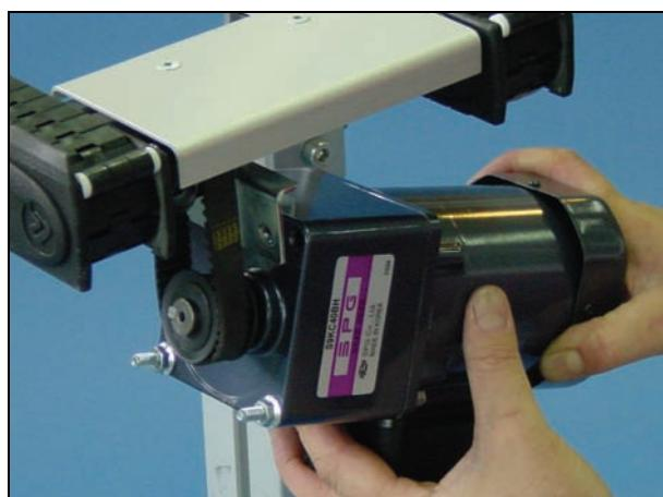
5 安装固定电机的螺丝。
