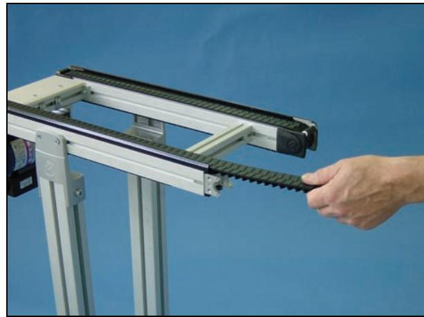
8 注意链条只可单向安装，即使链条是双向的。应始终按图片所示方向将链条安装到惰轮端至传动端之间的横梁顶端。
