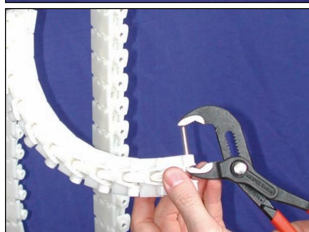
16 将链条端对接。确保保留节球并颠倒重新装配。
