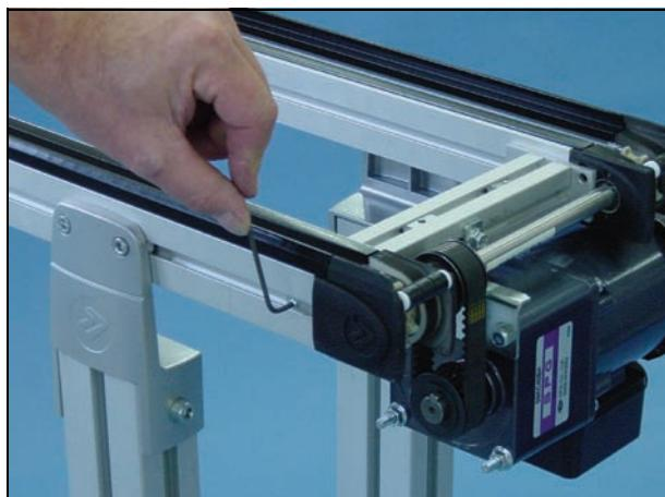
11 放置定距垫圈并安装传动装置盖。
