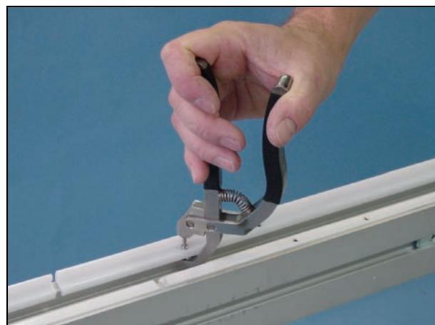
11 检查铆钉不让其凸出滑轨表面。检查滑轨的上下表面是否有金属凸出。
