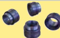
Para montar palets no estándar junto con placas de palets suministradas por el cliente. Los casquillos están diseñados para un espesor de placa de 5 mm y deben colocarse a presión en orificios de Ø 16 mm.
