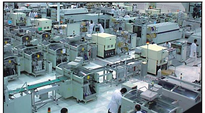
Línea de montaje de tarjetas de circuito impreso
