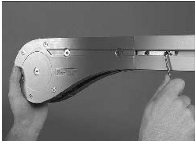
2 Fixe a unidade de roda livre na viga usando uma chave Allen para apertar os parafusos de ajuste.
