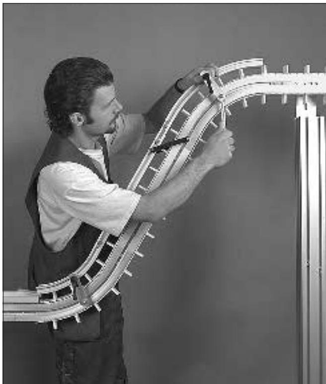
3 Fixe os suportes de curva e o dispositivo de bloqueio na peça dianteira e na viga de transporte. Os suportes de curva são montados somente de um lado.
