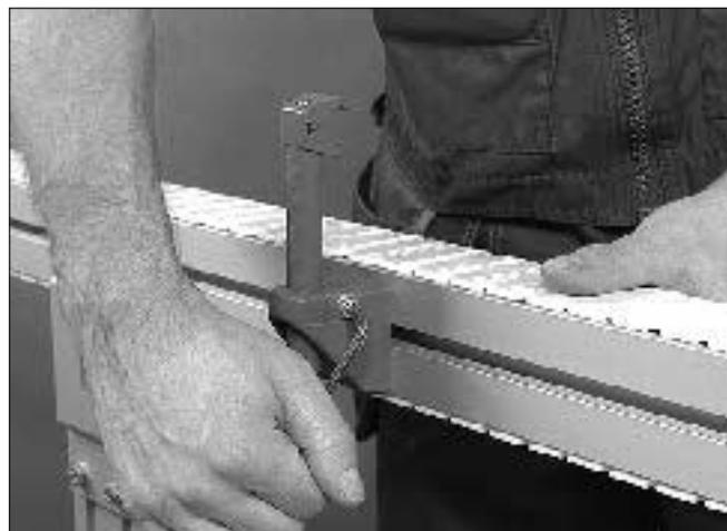
2 Instale um grampo para trilho de guia no suporte. Aperte o parafuso.
