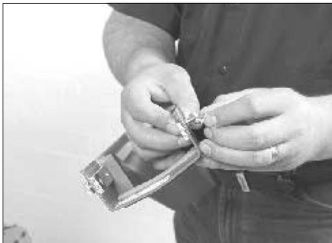
1 Fixe porcas quadradas em uma extremidade da bandeja de gotejamento e aperte-as um pouco. (Use duas em X\_DC, X\_DD e X\_DE; quatro em X\_DJ e X\_DH.) Faça a goteira deslizar para uma seção da bandeja.
