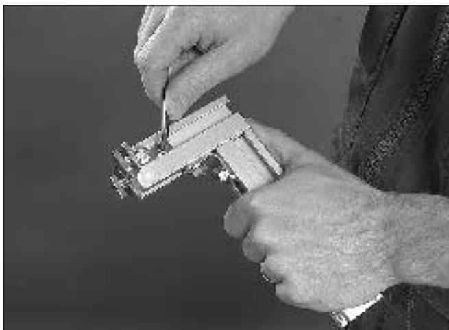
2 Aperte duas ferragens interiores XMRX 20 na extremidade do suporte em L.
