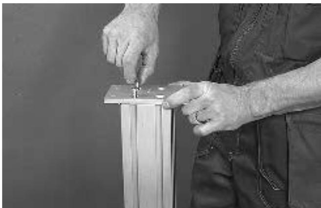
1 Acople uma placa de montagem na extremidade da viga, usando parafusos Allen MF6S 8x30 e arruelas.
