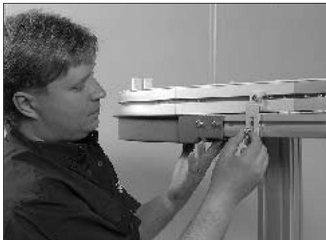
1 Use parafusos em T, porcas e arruelas para instalar suportes de bandejas de gotejamento na ranhura em T da viga transportadora.
