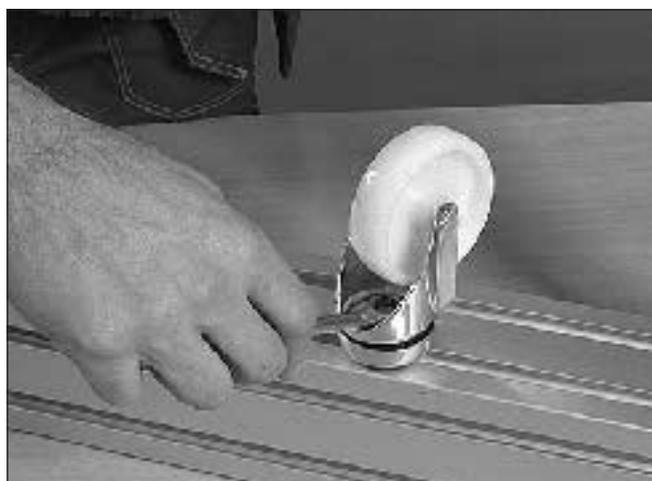
4 Parafuse a roda castor na viga com uma chave.
