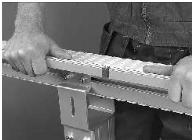
Cavilhas de conexão são prensadas para duas extremidades de trilho de guia .
