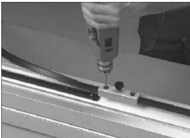
5 Use o suporte de furação para abrir dois furos no flange superior do trilho de deslizamento, antes de o enfiar na viga XKCB N.
