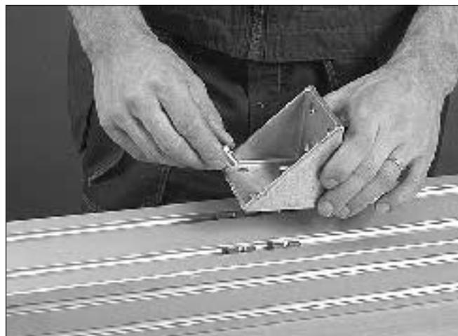
2 Introduza um número suficiente de porcas de fenda na ranhura em T da viga estrutural. Instale o suporte angular usando parafusos e arruelas.
