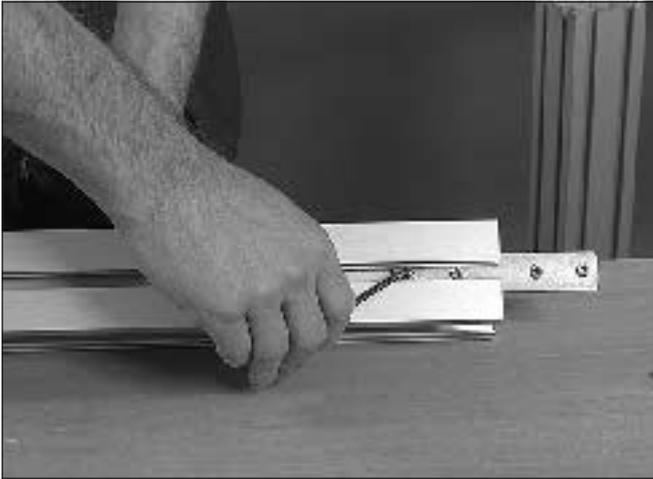
1 Acople duas pontas de viga de transporte inserindo faixas de união nas ranhuras em T das vigas. Use duas faixas em cada junta de vigas.
