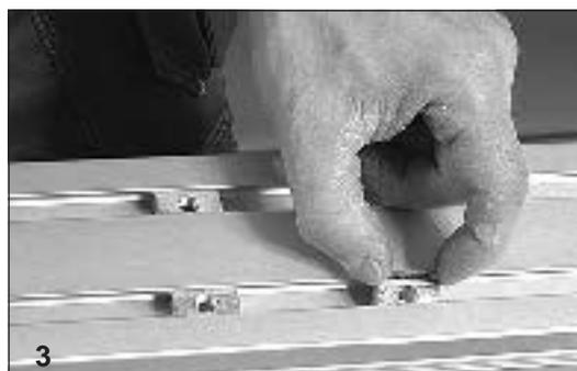
Para vigas pequenas (p. ex. XCBB ..x24x44), a porca deve ser inserida pela extremidade, em consequência do desenho dessas vigas.
