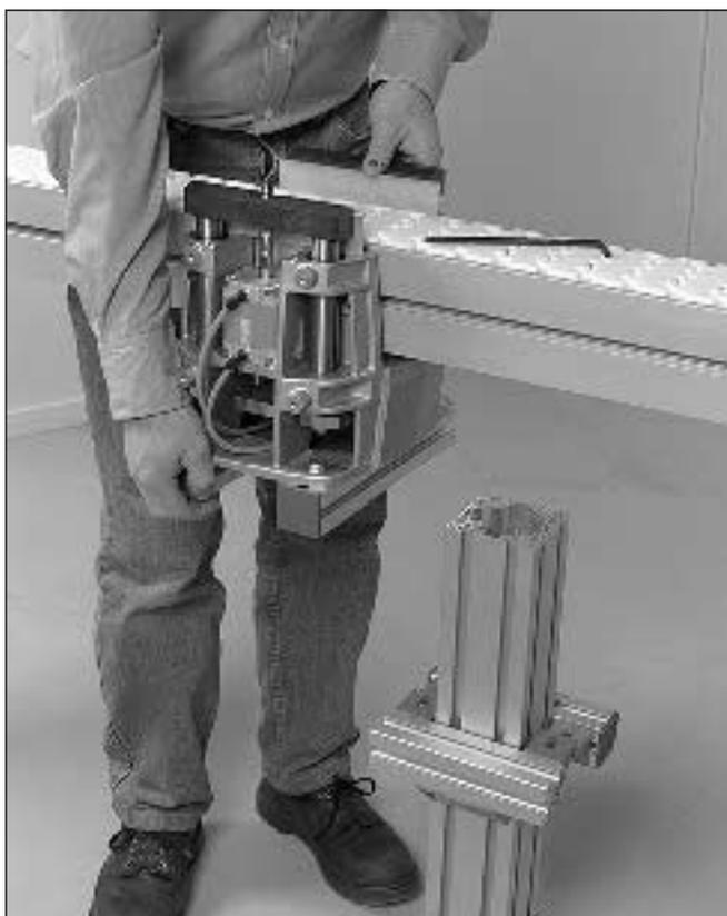
10 Levante o posto de localização e coloque pinos de guia na ranhura em T de um lado da viga transportadora.
