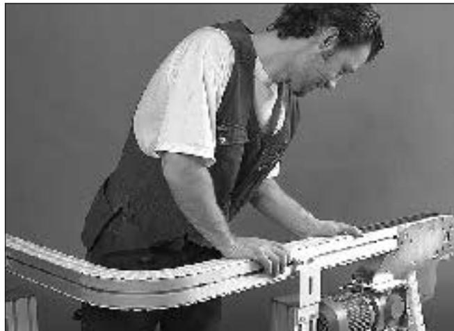
2 Faça com que a corrente percorra o transportador todo, puxando-a através da unidade de roda livre e voltando para a unidade motriz.
