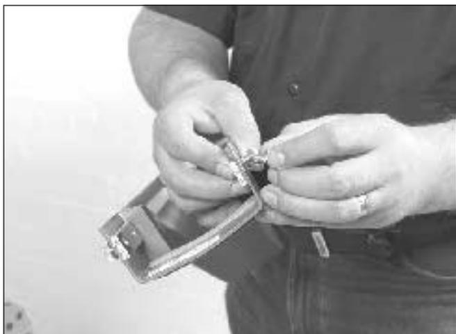
1a Instale duas porcas quadradas na goteira.
