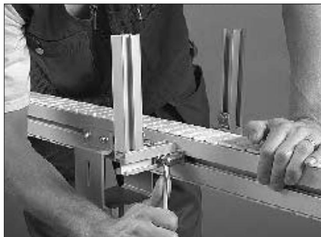
3 Instale o suporte na viga transportadora usando parafusos em T, porcas e arruelas.
