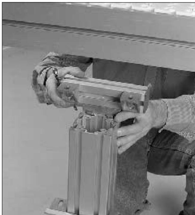
9 Introduza porcas quadradas nas ranhuras em T da viga vertical. Use suportes angulares para montar segmentos pequenos de viga XCBM 44 na viga vertical.
