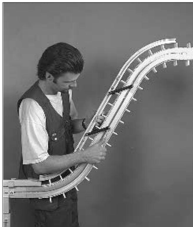
2 Fixe os pares de suportes, dois em cada lado, primeiro na peça dianteira e depois na ranhura em T da viga do transportador. Use uma chave de 13 mm.
