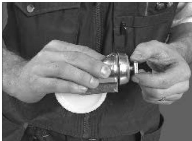
2 Insira o parafuso e a arruela espaçadora no furo do jugo da roda castor. Junte a arruela e a porca de fenda.
