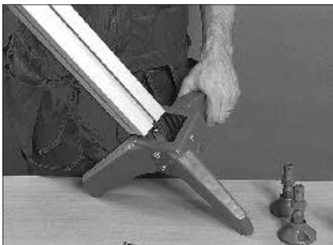
1 Monte o pé na ponta da viga introduzindo os grampos de compressão na ranhura em T da viga.
