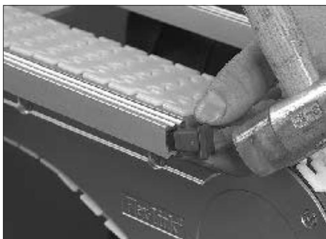
Instale capas terminais nas extremidades das vigas todas usando um martelo suave.
