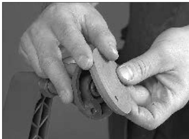
2 Os absorventes de vibrações são instalados no fundo dos acessórios de ajuste.
