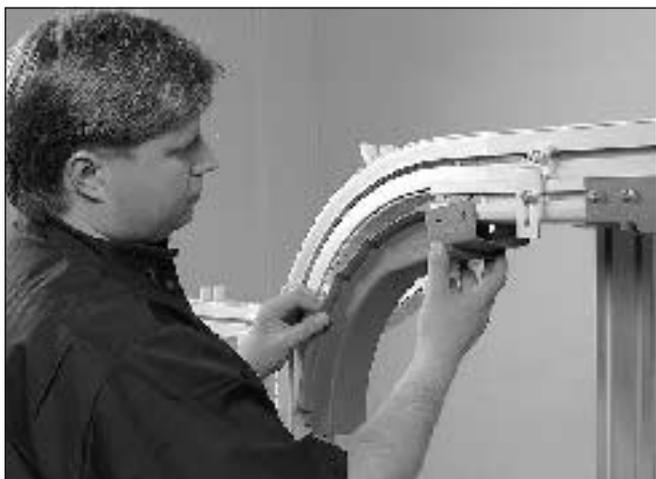
2 Monte a goteira na viga, sem apertar os parafusos a fundo. Verifique se a goteira acompanha a curva da viga de transporte. Se não o fizer, ajuste a sua posição até que acompanhe.
