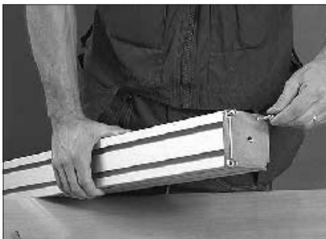
1 Acople a placa terminal na viga inserindo quatro parafusos Allen nos furos da placa terminal.
