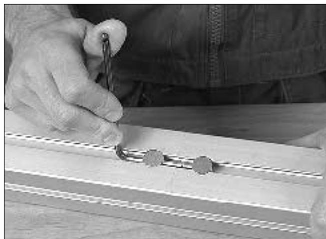
4 Conecte os jugos do outro lado da viga. Aperte ambos parafusos.
