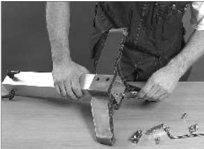
1 Acople o conjunto de ajuste de altura no pé introduzindo as travas nas ranhuras da viga.
