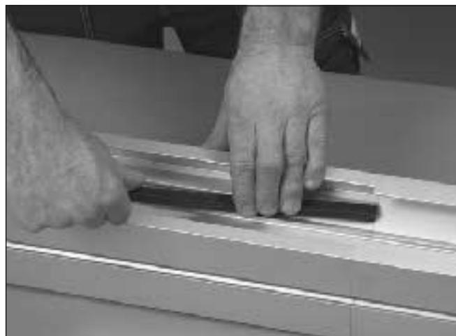
2 Instale o trilho de deslizamento no flange inferior da viga transportadora.
