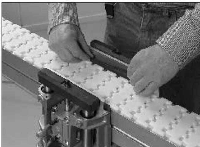
14 Coloque dois espaçadores (espessura 2,5 mm) entre o posto de localização e a viga transportadora, um a cada lado da viga, para manter o posto de localização centrado.
