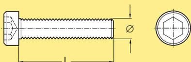
Vis d'assemblage à tête hexagonale,
