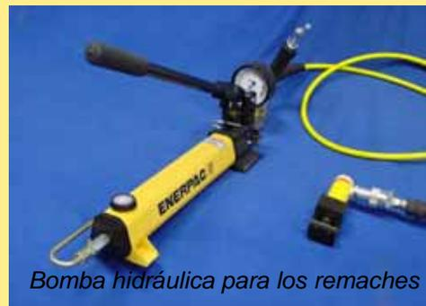
Bomba hidráulica para los remaches
