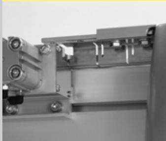
La butée est fournie avec un capot pour le levier d'arrêt. Les dimensions du capot ont été conçues pour qu'il puisse être utilisé avec les palettes les plus grandes. Il peut être facilement découpé pour être adapté aux autres types de palettes. Le capot est fixé à la rainure en T du guide.
