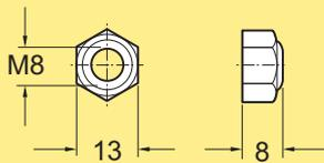
Écrou de blocage à filet M8 pour rainure en T
