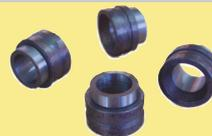
Per comporre pallet non standard in combinazione con piastre pallet fornite dal cliente. Le boccole sono progettate per uno spessore di piastra di 5 mm e devono essere fissate a pressione in fori da Ø16 mm.
