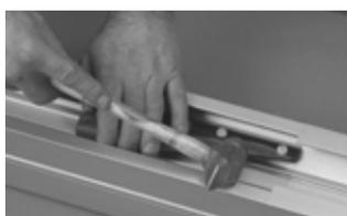
5 Sur la lèvre supérieure de la glissière, utiliser le gabarit de perçage pour percer deux trous dans la glissière avant qu'elle pénètre dans le profilé XKCB N.
