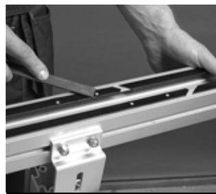
Contrôler que les surfaces supérieure et inférieure de la glissière ne présentent pas de protubérances métalliques ou plastiques.
