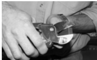
3 Enfoncer la glissière latérale en place à une extrémité de la courbe. Il est important qu'elle soit placée contre la lèvre inférieure du profilé.
