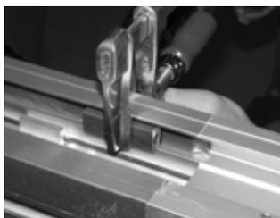
7 Fixer à l'aide de vis pour tôle ISO 7049 4,2 x 9,5 Voir « Glissière latérale pour courbes sans roue XH » à la page 226. (ne jamais utiliser des vis d'une longueur supérieure à 9,5 mm).
