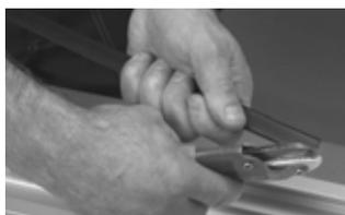
2 Monter la glissière sur la lèvre inférieure du profilé convoyeur.
