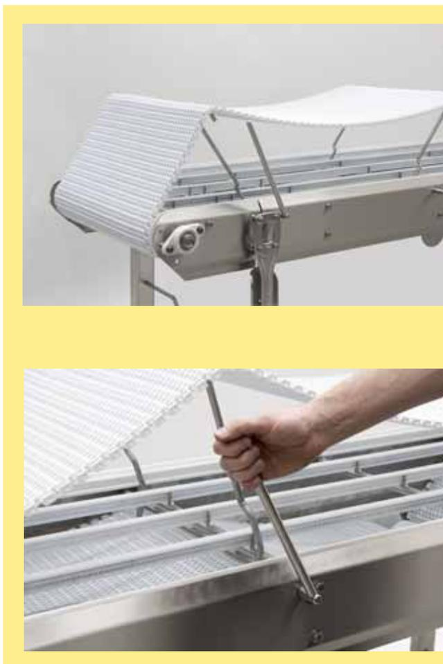
Pour simplifier le processus de nettoyage, FlexLink propose des bras de levage de chaîne pour convoyeurs rectilignes. Contacter FlexLink pour obtenir plus d'informations.
